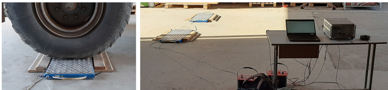
Abbildung 13: Messaufbau Achswiegungen während der Getreideernte
