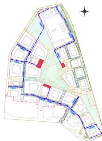
Abb. 12: Schematisches Regenwasserkonzept der L416 GmbH, Leipzig, 2020 (Bildquelle: LfULG, Bericht: Bodenfunktionen in der Schwammstadt, 2021)
