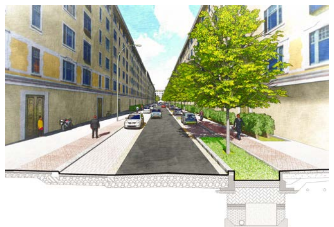
Abb. 11: Ansicht einer Baumrigole mit unterirdischem Speicherraum am Pilotstandort Kasseler Straße in Leipzig (Quelle: © Ingenieurgesellschaft Prof. Dr. Sieker mbH)
