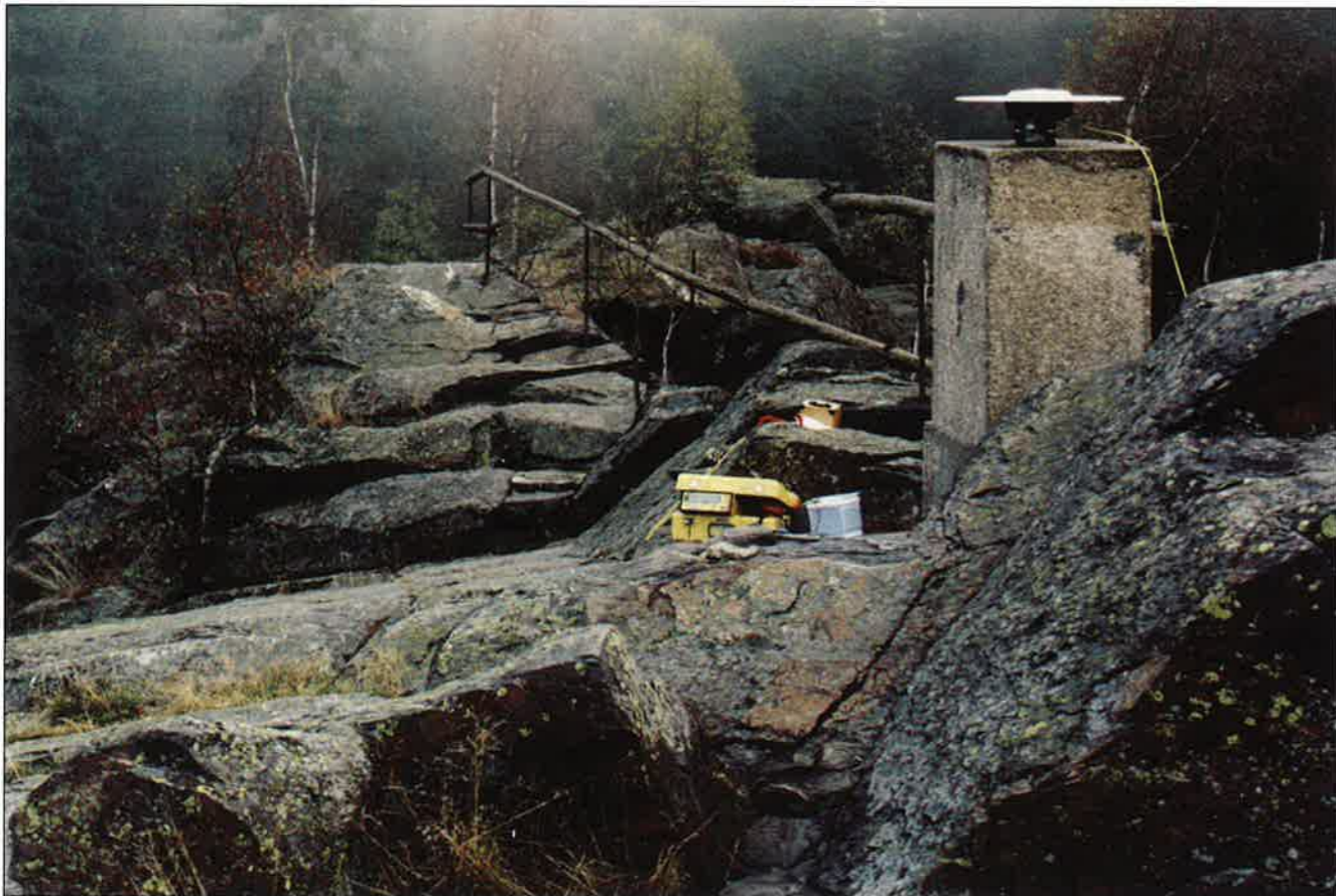
Abb. 9: 12-stündige geodätische GPS-Messungen auf einer Station des Überwachungsnetzes Vogtländisches Bebengebiet. Die Antenne (schwarz-weiß) für den Empfang der Signale der GPS-Satelliten ist auf dem Pfeiler aufgeschraubt. Der Empfänger (gelb) befindet sich am Fuße des Pfeilers.
