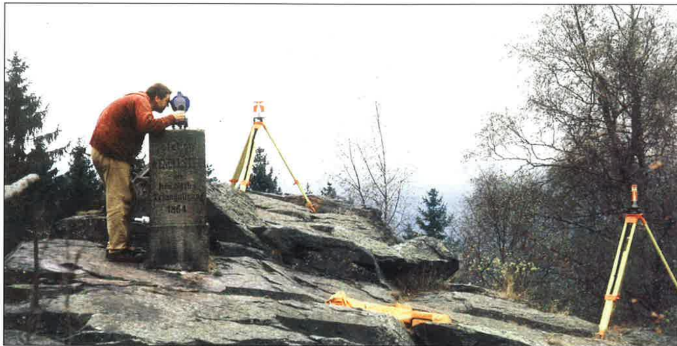
Abb. 8: Überprüfung der Stabilität einer aus einem Zentrum und zwei Exzentren bestehenden Punktgruppe durch elektronische Richtungs- und Streckenmessungen hoher Genauigkeit
