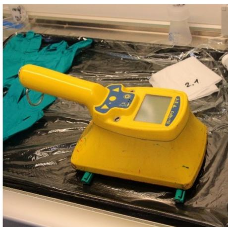
Abbildung 2: Messungen mit einem Kontaminationsmonitor vom Typ CoMo 170
