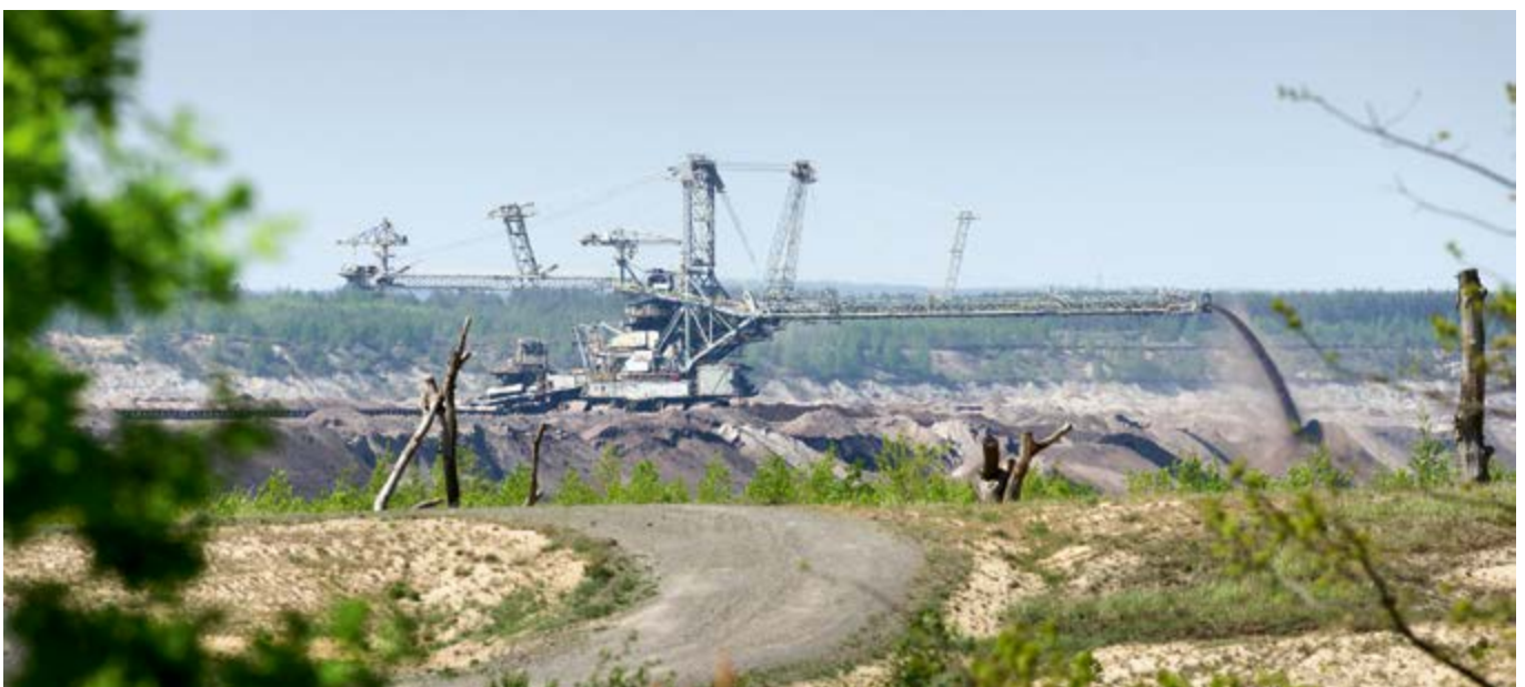
Blick vom Turm in den Tagebau Nochten – Absetzer bei der Verkipfung von Abraum
