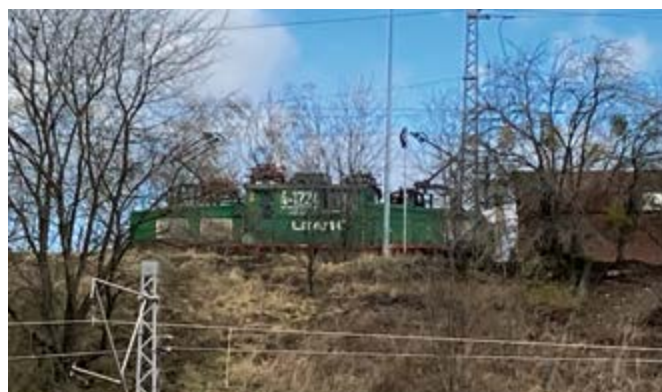
Elektrische Grubenlokomotive EL 2m, hergestellt im VEB Elektrotechnische Werke »Hans Beimler« (LEW) Hennigsdorf von 1952 bis 1988 in 1384 Exemplaren, in Schwarze Pumpe
