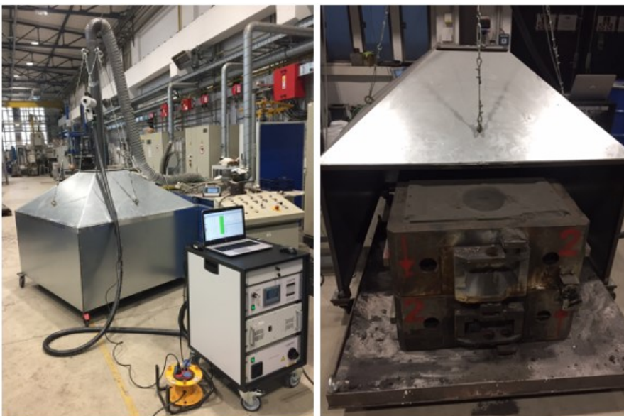
Abbildung 2: Absaughaube mit regelbarem Volumenstrom (links), abgussbereite Grünsandform unter der Haube (rechts)
