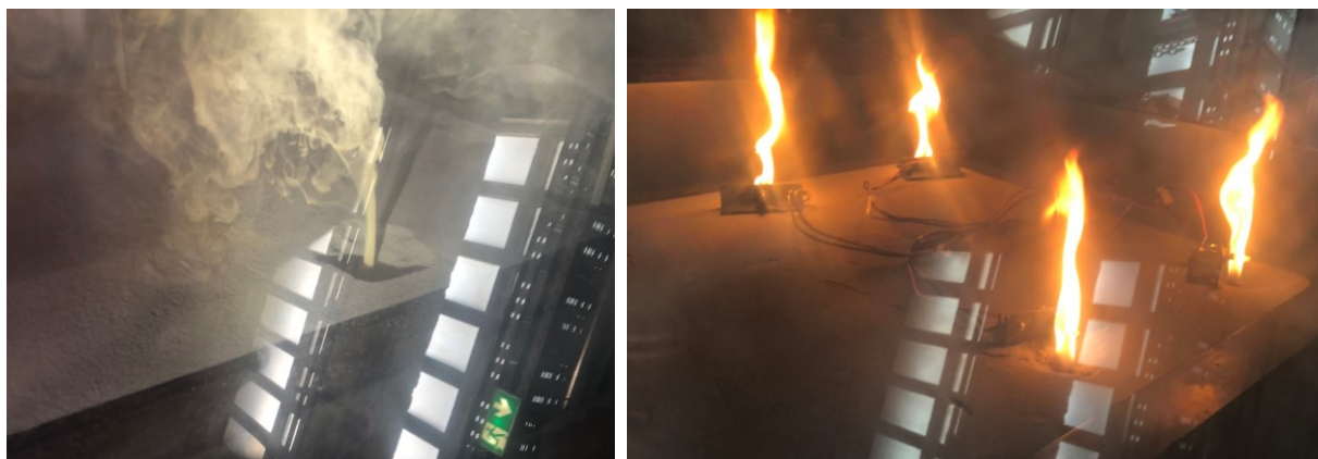
Abbildung 35: Veranschaulichung der austretenden Pyrolyseprodukte bei aktiver Kernentlüftung (links) und Flambild bei Zündung dieser Pyrolyseprodukte
