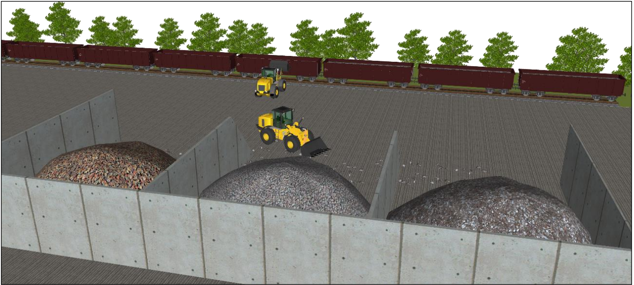
Abbildung 55: Ebenerdige Verladung aus Schüttgutboxen 22
