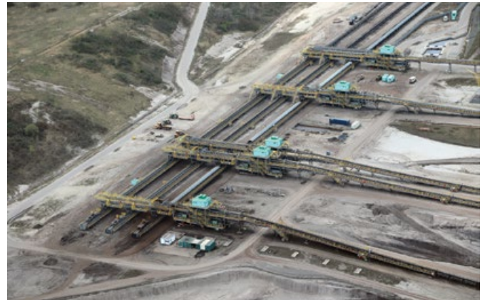
Transport der Rohbraunkohle, Massenverteiler im Abbaufeld Peres
