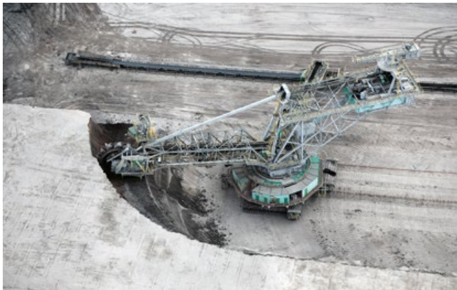
Gewinnung der Rohbraunkohle, Schaufelradbagger 1528 SRs 2000 und Bandwagen im Abbaufeld Peres
