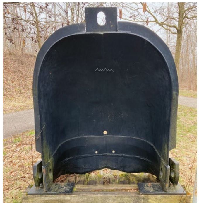
Baggerschaufel des Schaufelradbaggers 1498 aus dem Tagebau Espenhain
