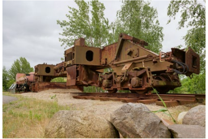
schienegebundener Birkpflug zum Verschieben von Kies im Gleisbett
