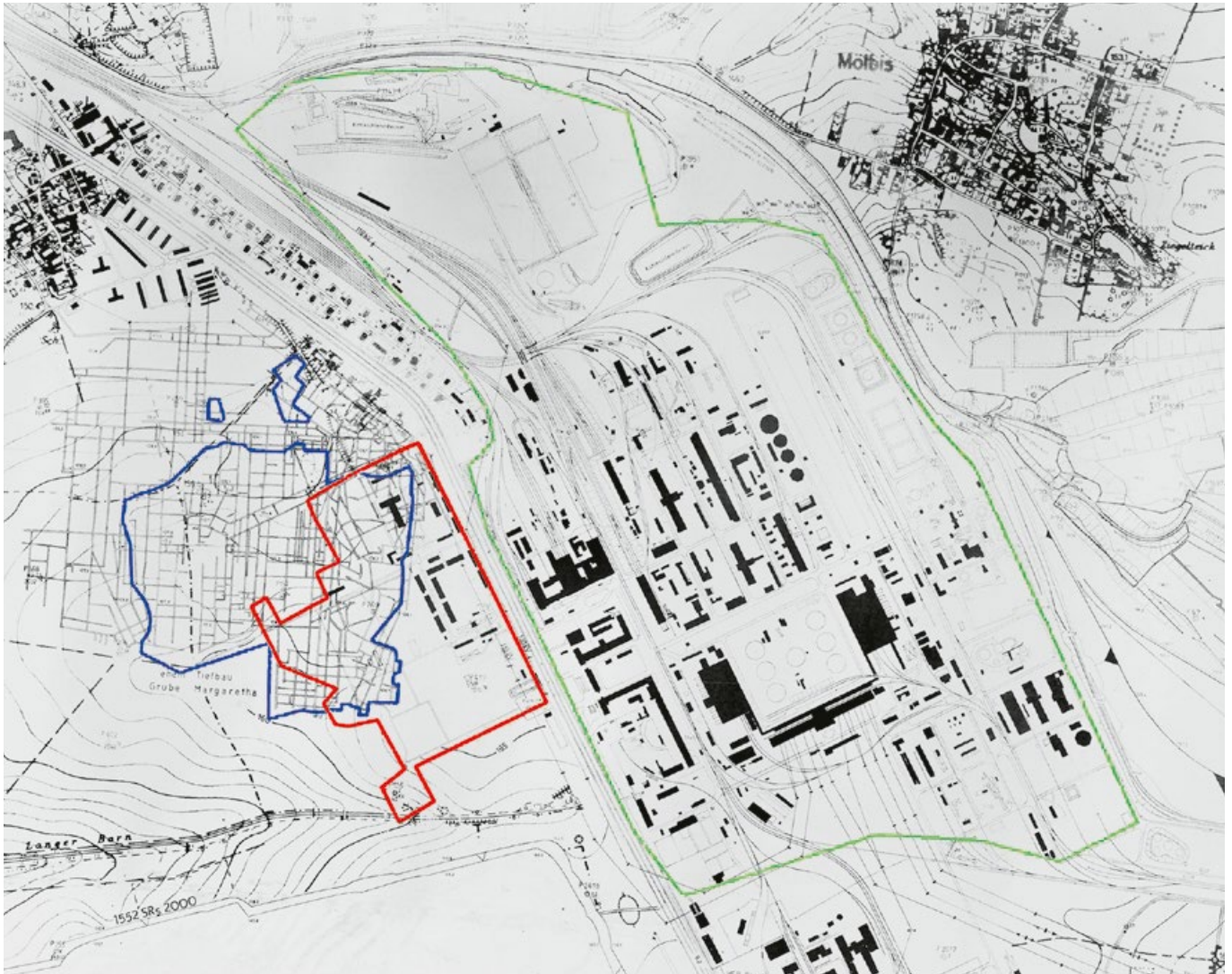
Überlagerung verschiedener Nutzungsschichten am Standort Espenhain mit Grubenriss zum Tiefbau der Gewerkschaft Grube Margaretha (blaues Polygon mit im digitalen Geländemodell nachweisbarem tatsächlichen Abbaubereich), überlagert von der im Plan noch ablesbaren Barackenstruktur des Wohnlagers Espenhain (rotes Polygon) und der Fläche des Braunkohlenveredelungswerkes Espenhain (grünes Polygon). Übersichtskarte Espenhain Maßstab 1:5 000, 1966
