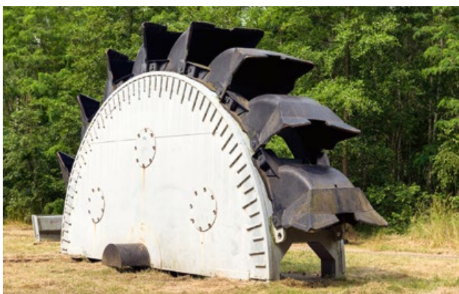
Schaufelradhälfte des Schaufelradbaggers 1529 aus dem Tagebau Espenhain
