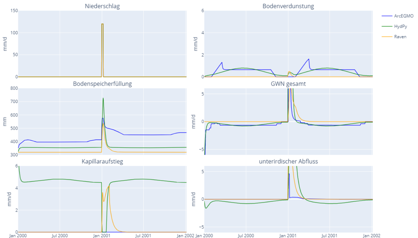
Abbildung 46: Zeitlicher Verlauf ausgewählter Wasserhaushaltsgrößen der drei cF-Modelle im Gesamtzeitraum für das Niederschlagszenario "pblock" (Landnutzung unbewachsener Boden, Bodenart Ls3), im Nichtereigniszeitraum entspricht "GWN gesamt" dem Kapillaraufstieg in ArcEGMO
