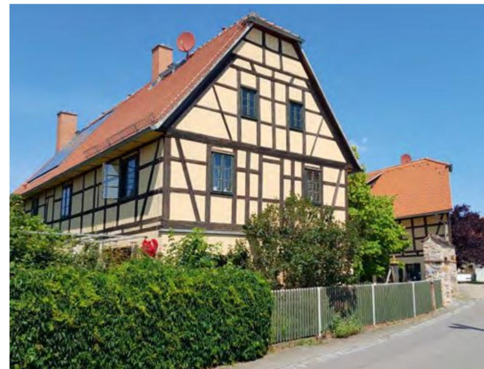
Der Dreiseithof aus dem 18. Jahrhundert steht U-förmig zur Straße geöffnet inmitten des durch historische Hofanlagen geprägten Ortskerns. Die Photovoltaikanlage wurde auf der vom Hof abgewandten Seite des Wohnhauses möglichst weit von der Straße abgerückt und dachintegriert ausgeführt. Sie ordnet sich dadurch dem authentischen Erscheinungsbild der Hofanlage unter.
