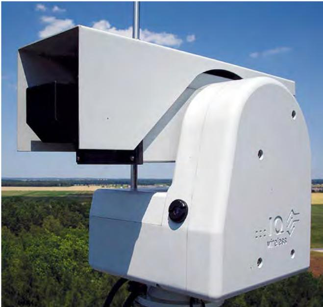
Abb. 10.5: Detektionseinheit (Kamera) des AWFS-Systems auf einem Feuerwachturm
