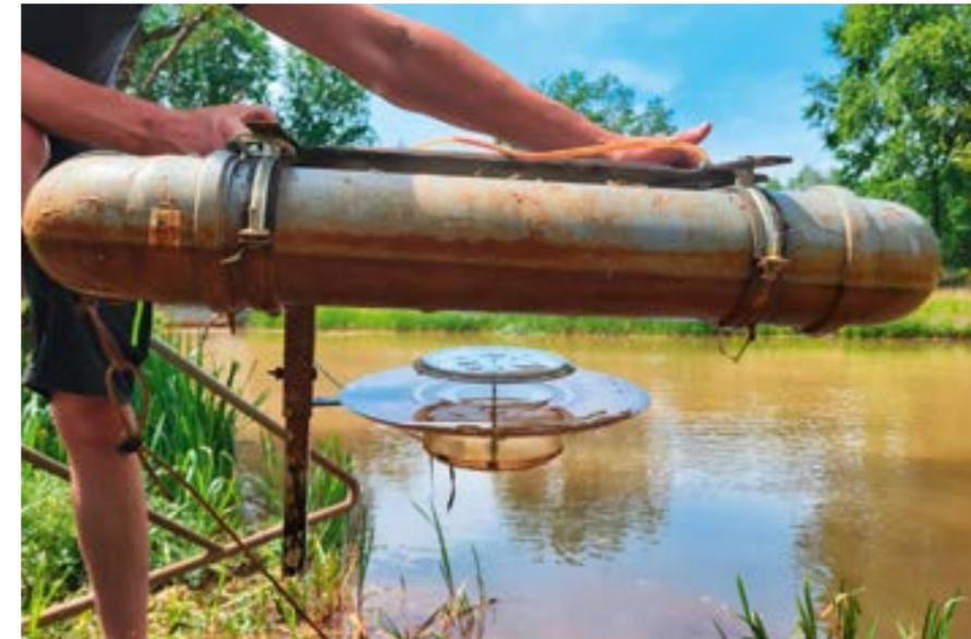
Abb. 10: Befestigung einer Tellerfalle an einem Schwimmkörper
