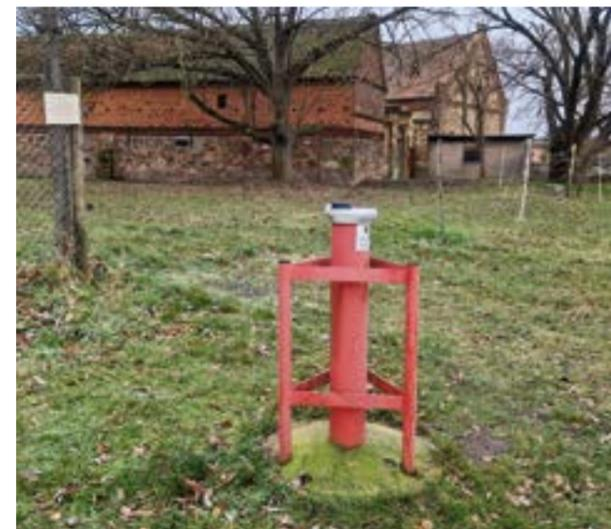
Abb. 5: Grundwassermessstelle mit neu ausgerüsteter Datenfernübertragung
