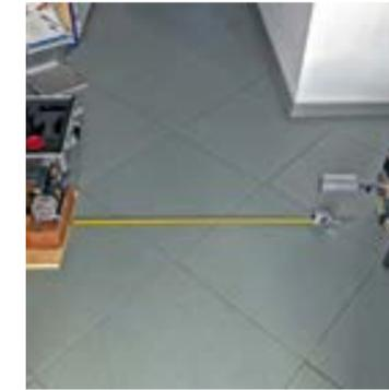
Abb. 4: Überprüfung einer radioaktiven Quelle (links) mit Hilfe der in-situ-Gammaspektrometrie (rechts)
