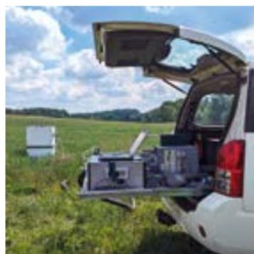
Abb. 4: Mobile Installation der FTIR-Spektrometrie. Im Hintergrund ist die Messhaube zu sehen
