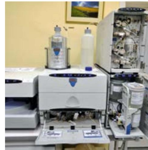
Abb. 7: Ionenchromatograph mit integrierter Matrixabtrennung
