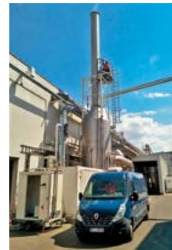
Abb. 5: Messwagen an einer Emissionsstelle in einem Holzverarbeitenden Betrieb
