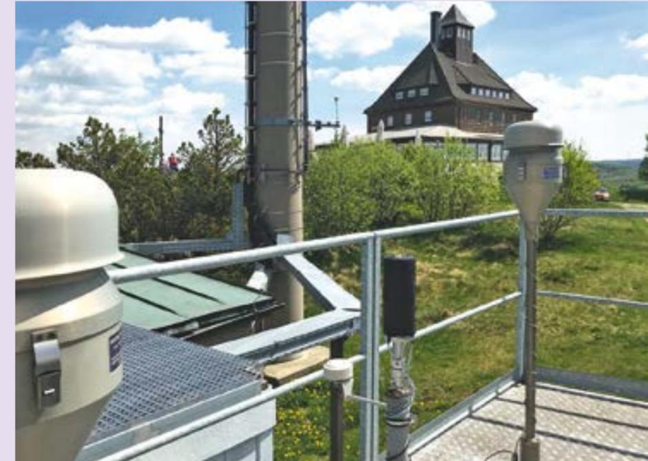
Abb. 2: Dach der Luftgütemessstation am Schwarzenberg mit Probenahmeköpfen
