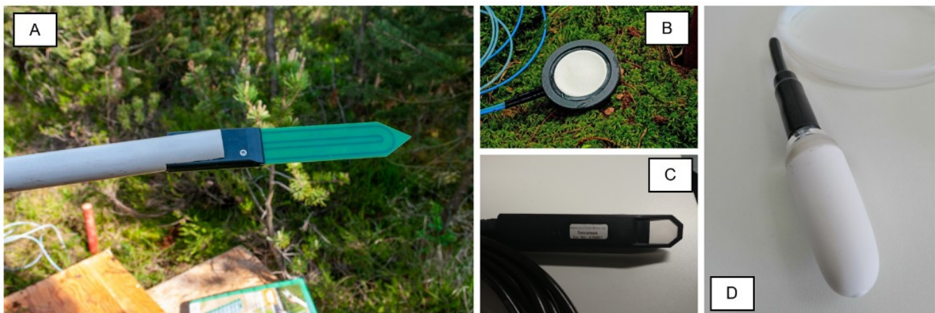
Abbildung 14: Im Boden installierte Sensoren und Instrumente an den vier Bodenmessplätzen an der TS Sosa: Bodenfeuchtesensor SMT100 [A]; Saugplatte [B]; Tensiometer Tensiomark [C]; Saugkerze [D]
