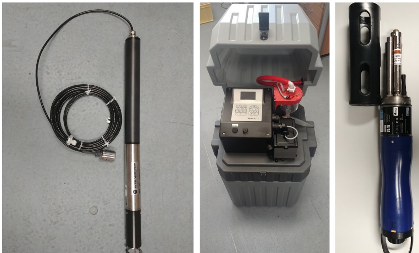
Abbildung 21: An den hydrologischen Messplätzen installierte Instrumente; Drucksonde [links], Automatischer Probenehmer [Mitte], Multiparametersonde YSI-EXO3 [rechts]
