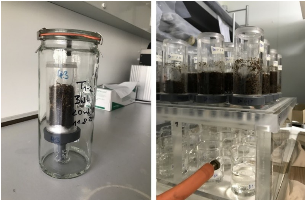
Abbildung 23: Säule mit organischem Bodenmaterial befüllt platziert im Inkubationsgefäß während der Messung der Basalatmung nach (Isermeyer 1952) [links]; Säulen mit organischem Bodenmaterial befüllt platziert auf der Unterdruckeinheit während der Gewinnung der Perkolate [rechts]
