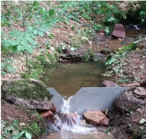
Abbildung 20: Foto eines V-Messwehres an der Talsperre Sosa (links) sowie eine schematische Darstellung (rechts)
