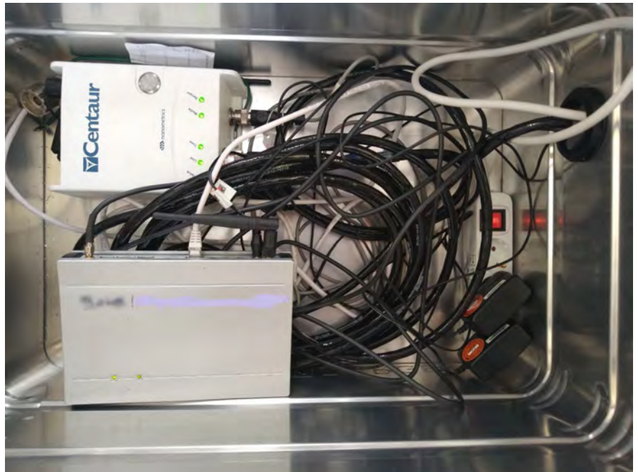
Abb. 3.3-3: Blick von oben in die Aluminiumkiste mit der Stationstechnik: Datenlogger und Router an der Station MENTE (Foto: D. Schönwald).
