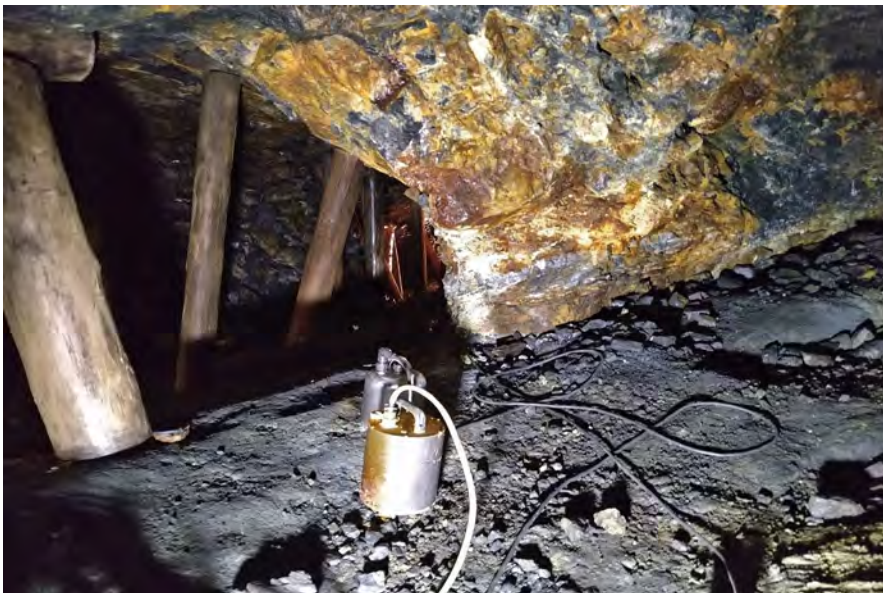
Abb. 3.3-2: Seismometer unter Tage im Schaubergwerk Morassina (Foto: D. Schönwald).
