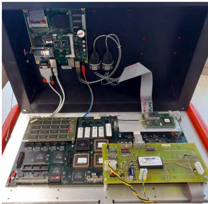
Abb. 3.1-2: Geöffneter Quanterra-Koffer. Unten (silberner Hintergrund) ist die originale Elektronik zu sehen, oben (schwarzer Hintergrund) finden sich links die zusätzliche Platine (Typ Alix, Größe ca. 15 x 15 cm) und weiter rechts Schnittstellenwandler und die zusätzliche Verkabelung (Foto: R. Voigt).
