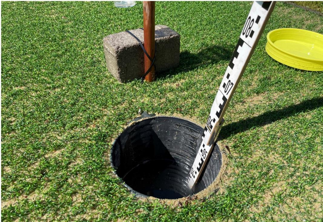
**Abbildung 19: Ablesen des Wasserstands im Beobachtungsrohr**
