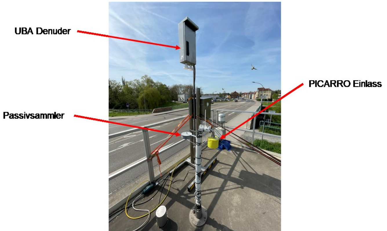
Abbildung 8: Das NH 3 -Denuder-Gerät des Umweltbundesamtes auf dem Dach der Luftmessstation Borna.
