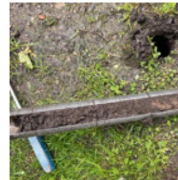
Abb. 5: Bodenprobe zur Prüfung einer möglichen radioaktiven Kontamination einer Kleingartenanlage
