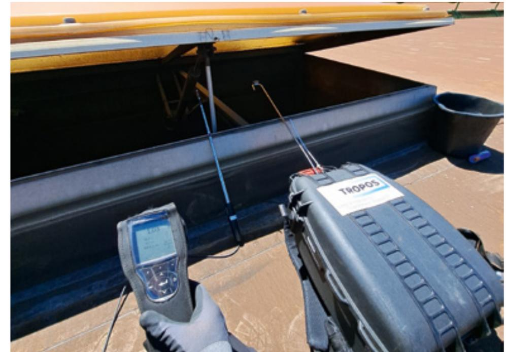
Abb. 4: Oberlicht am Eisenwerk orientierende Messung von Partikeln und Abgasrandbedingungen
