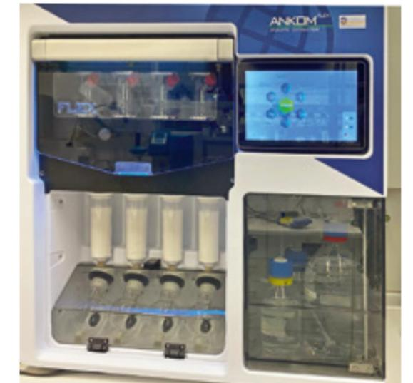
Abb. 3: Extraktionsgerät für die Analyse fettlöslicher Vitamine
