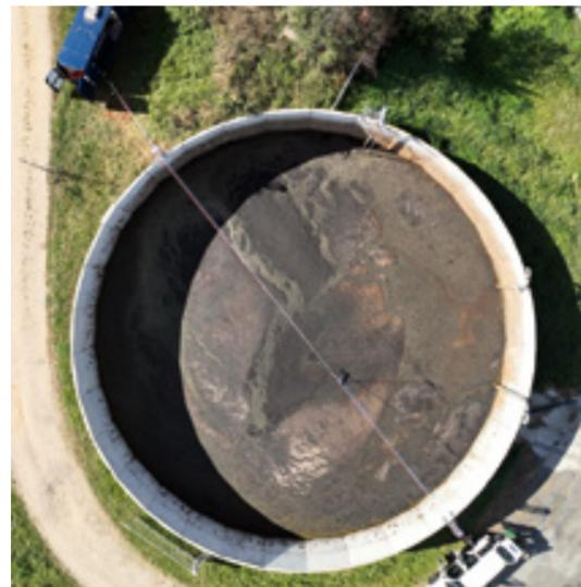
Abb. 7: Drohnenfoto eines Güllebeckens mit Position der Messhaube
