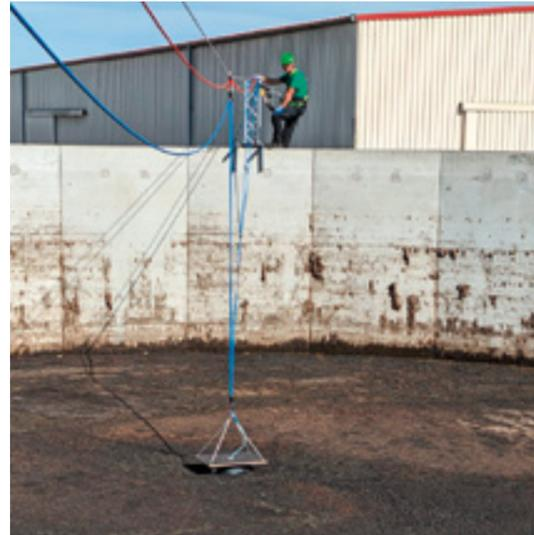
Abb. 6: missionsmessung über einem Güllebecken mit Hilfe einer an einer Seilbahn hängenden Messhaube
