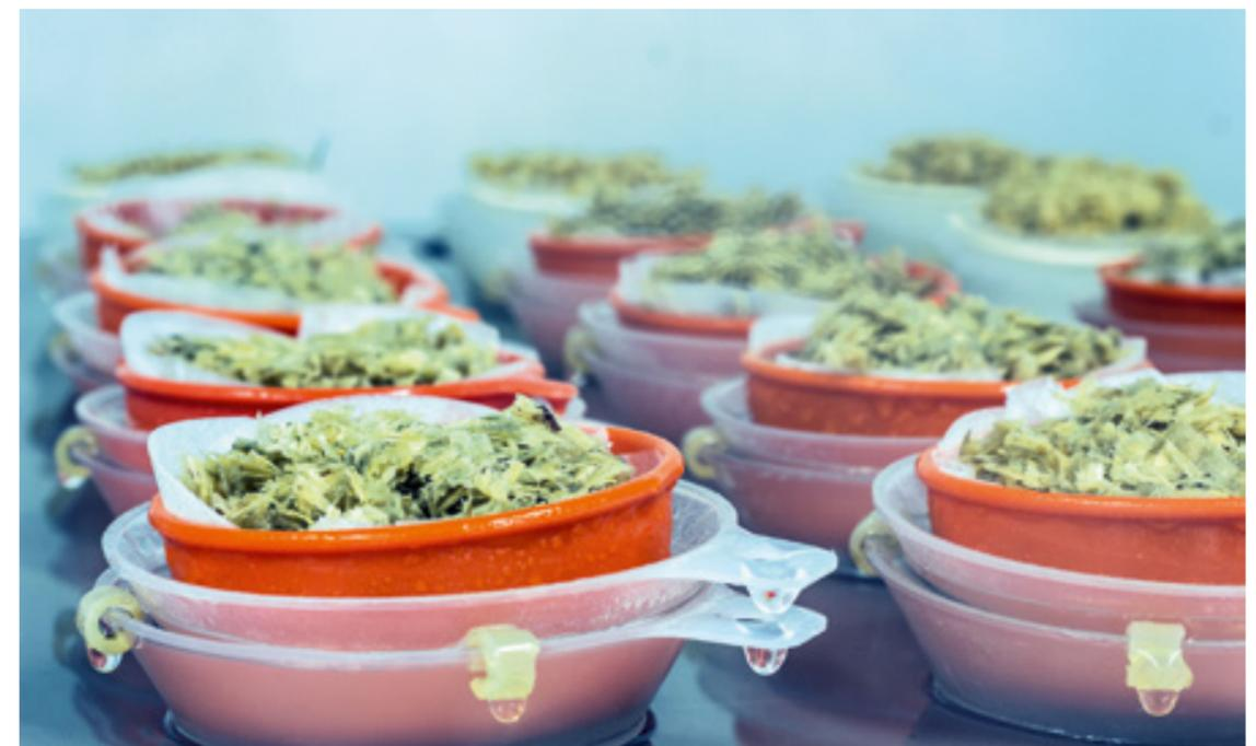
Abb. 7: Sprühnebelanlage zur Extraktion von Nematoden aus Kiefernspänen
