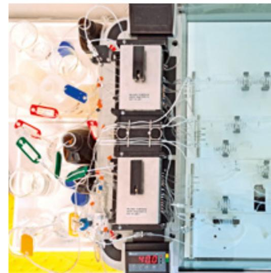
Abb. 11: CFA-Modul zur Bestimmung von NO<sub>2</sub>, Si, NH<sub>3</sub> und P in wässrigen Proben
