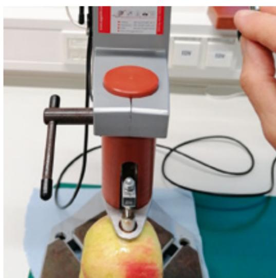
Abb. 5: Festigkeitsmessung von Äpfeln
