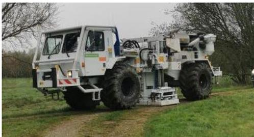
**Abbildung 8** Vibroseis-Fahrzeug der Firma Geofizyka Toruń
