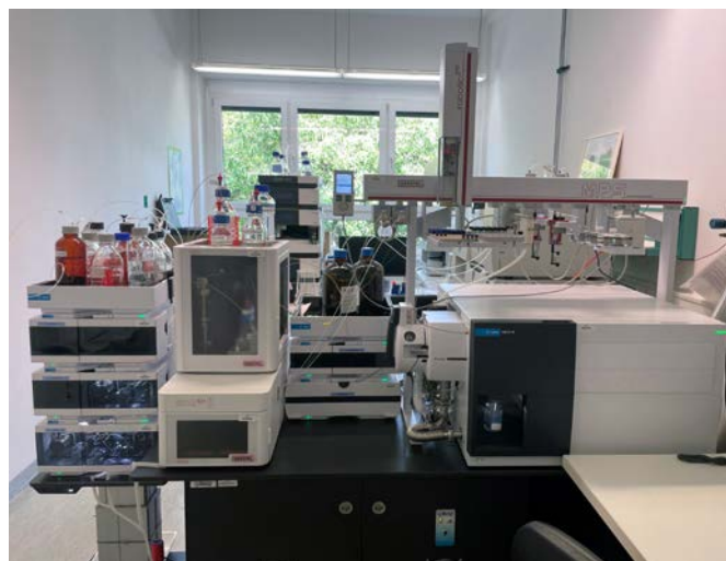
Abbildung 12: Modernes präparatives Analysegerät (LC-MS/MS) für die Spurenanalytik von Pflanzenschutzmitteln, organischen Schadstoffen und PFAS in Trinkwasser
