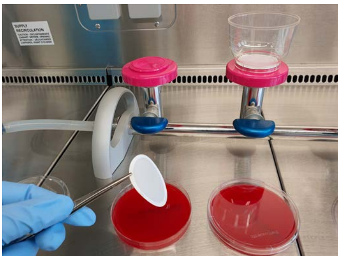
Abbildung 13: Hygienische Untersuchungen an aufbereiteten Endoskopen - Auflegen des Filterplättchens auf ein Nährmedium nach Membranfiltration von 10 ml Spülflüssigkeit aus einem Endoskopkanal
