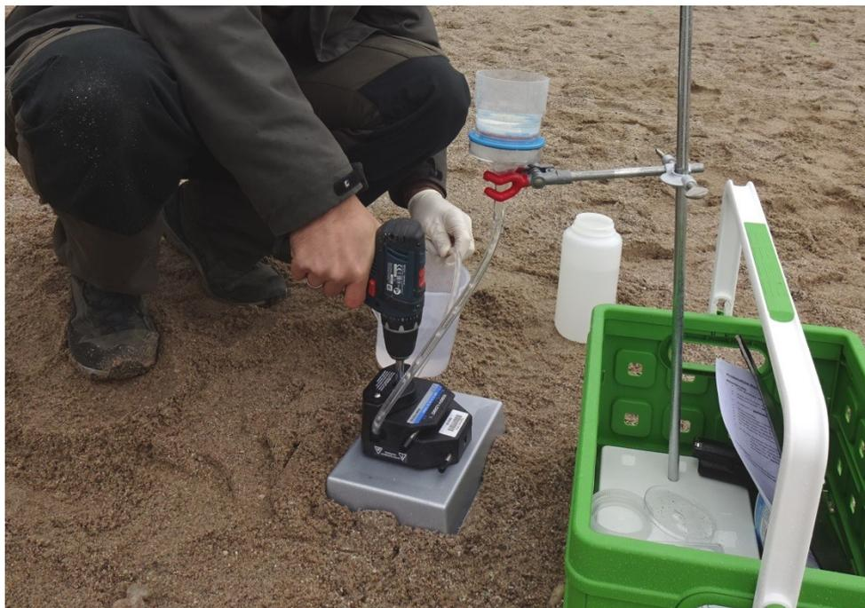
Abbildung 5: Filtration von Wasserproben im Gelände
