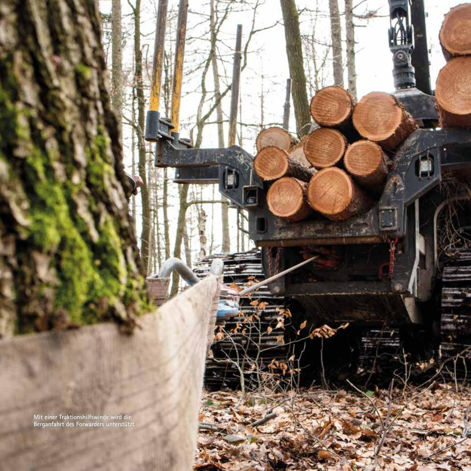
Mit einer Traktionshilfswinde wird die Berganfahrt des Forwarders unterstützt
