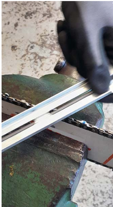
Abb. 10: Die Feile wird von innen nach außen geführt; Foto: Andreas Löbnitz
