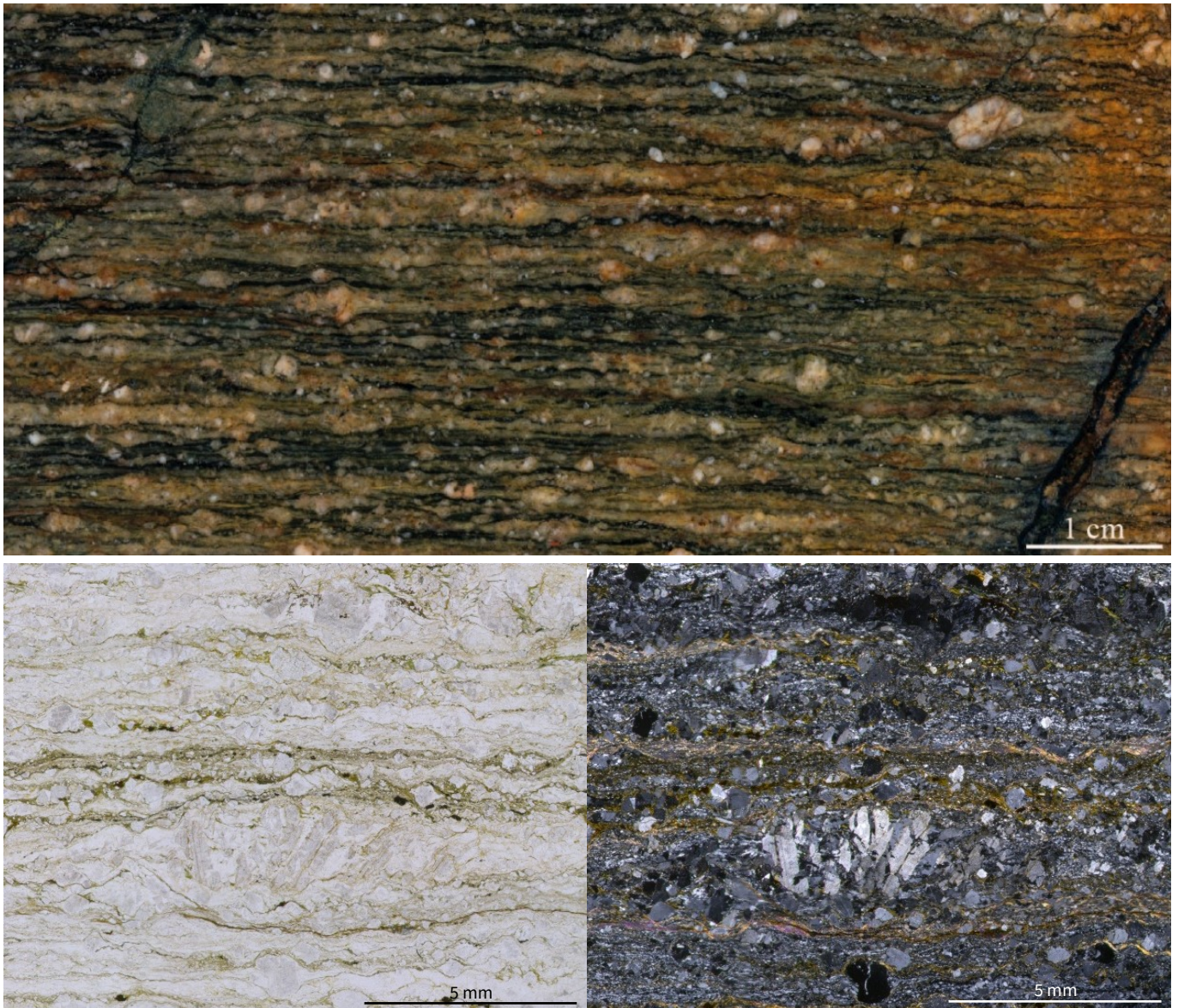
Abbildung 26: Mylonitischer Chloritgneis mit feinen Chloritlagen und breiteren Lagen aus Quarz-Feldspat-Mörtel sowie zerbrochenen Feldspatklasten.
