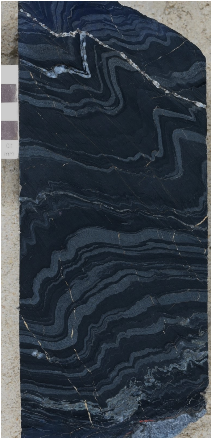
Abbildung 50: xz-Ebene einer gefalteten Tonschiefer-Grauwacke-Wechselagerung im Bohrkern.
