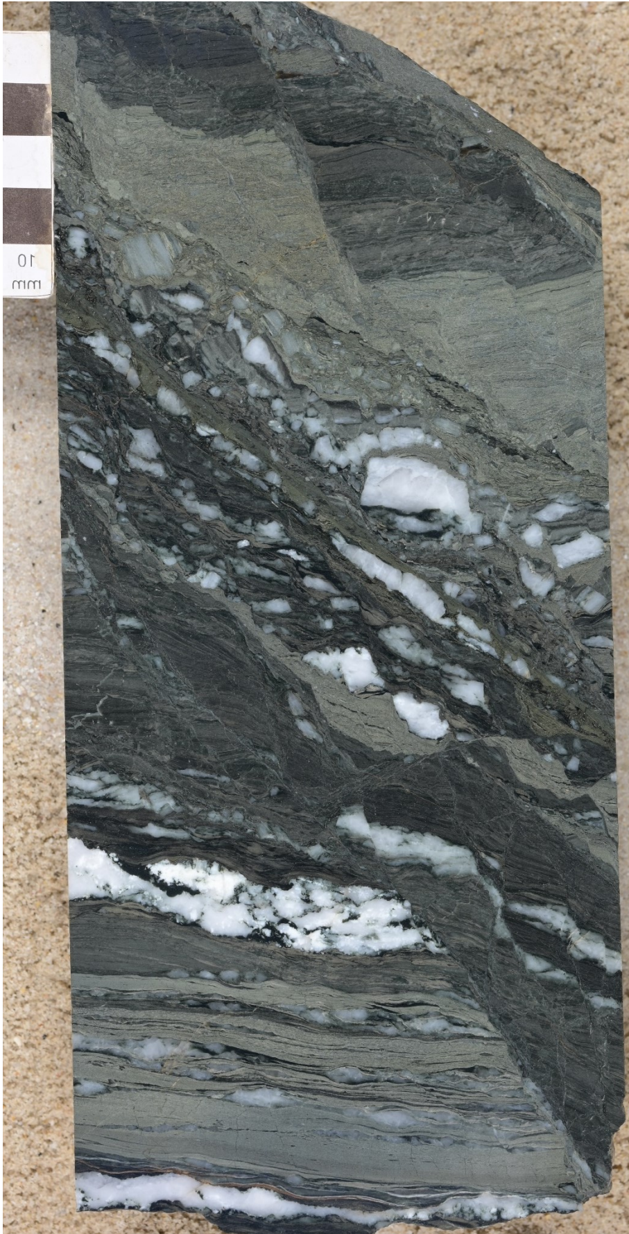
Abbildung 32: Gestörter phyllitischer Bohrkern mit zahlreichen Abschiebungen sowie mylonitischem Gefüge im unteren Part.
