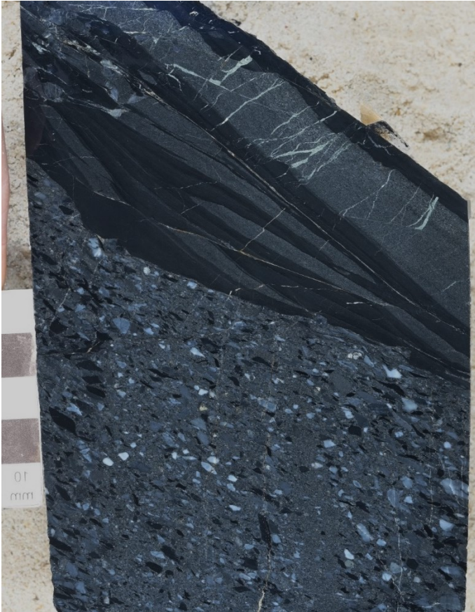
Abbildung 49: Scharfer Kontakt einer Tonschiefer-Grauwacke-Wechselagerung in der oberen Hälfte zum Kieselschiefer-Hornstein-Konglomerat in der unteren Hälfte in einem Bohrkern.
