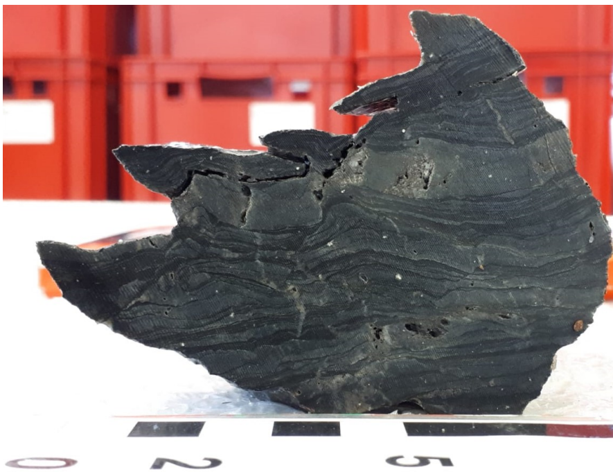
Abbildung 41: Handstück mit einer gestörten und verfalteten Tonschiefer-Grauwacke-Wechsel-lagerung.
