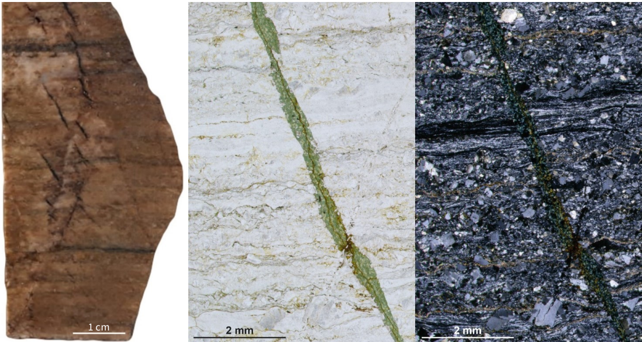
Abbildung 69: Kataklastischer Mylonit mit Glasrissen.
