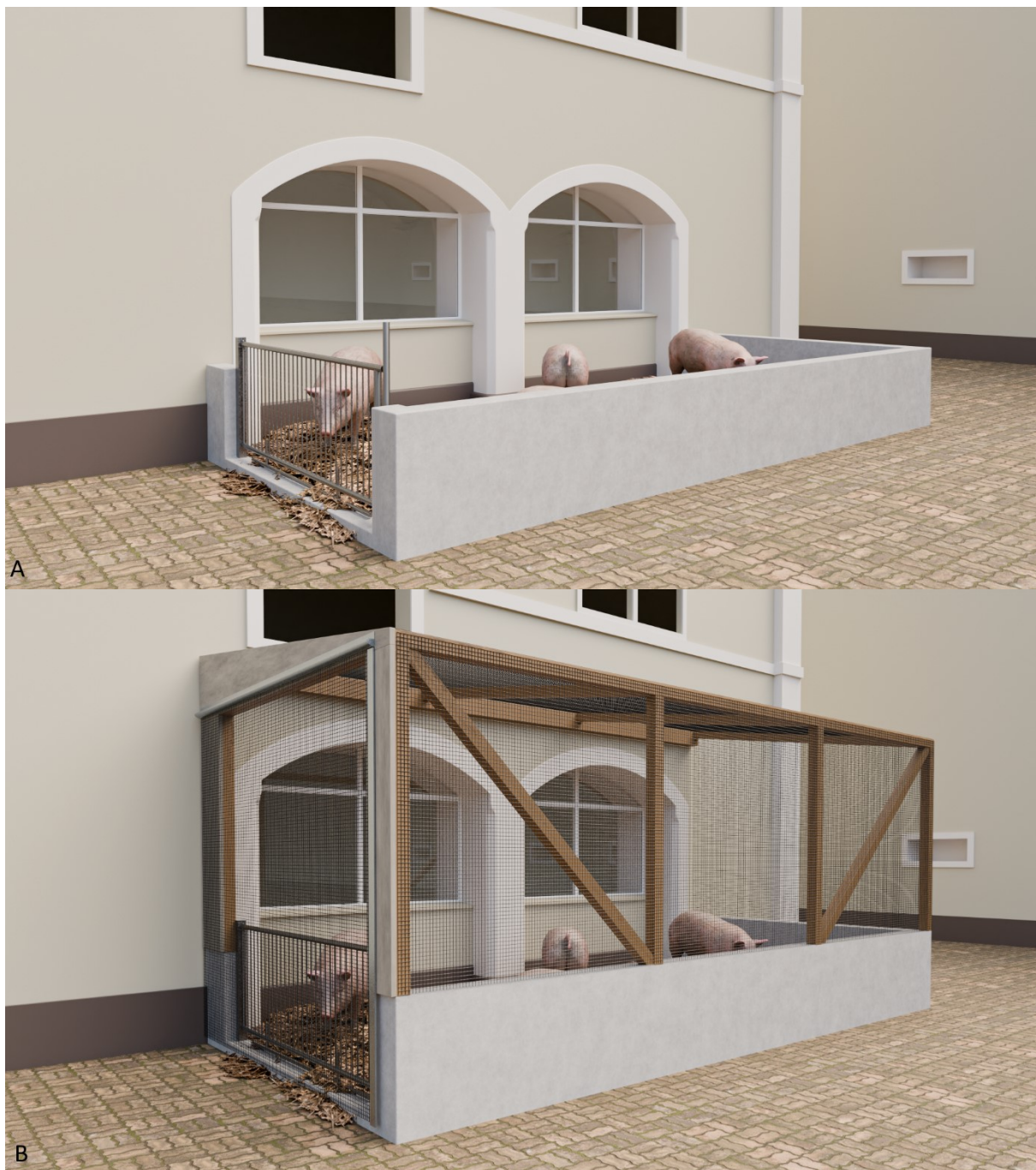
Abbildung 10: A) Der nicht überdachte Auslauf B) Der mobil überdachte Auslauf, mit Unterkonstruktion und Vogelschutznetz. Bildquelle: MollAnlagenbau GmbH & Co. KG
