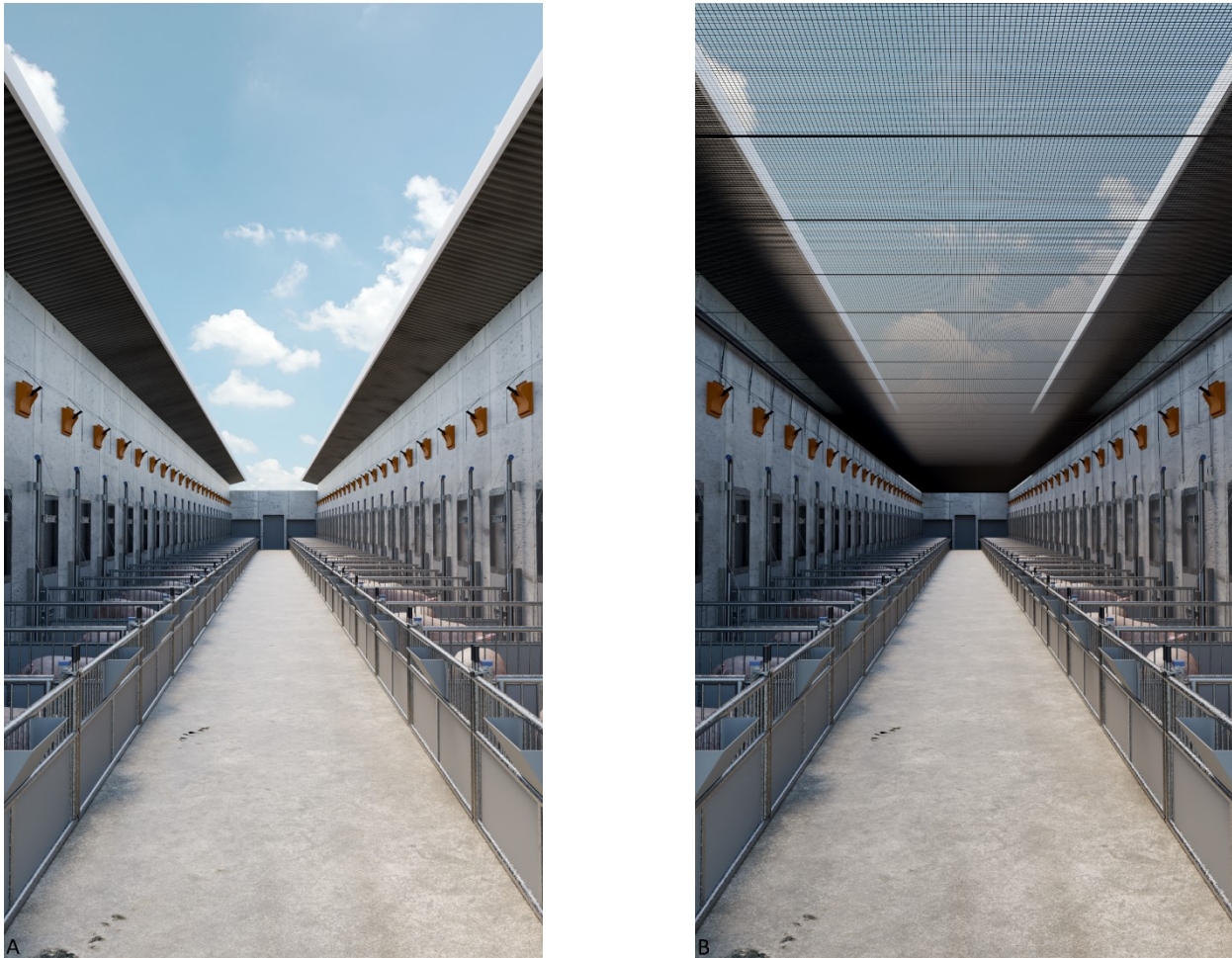
Abbildung 13: A) Der Auslauf ist innenliegend und bedarf somit keiner Unterkonstruktion, um Netze anzubringen. B) Der Auslauf wird durch Vogelschutznetze abgesichert. Bildquelle: Moll Anlagenbau GmbH & Co. KG
