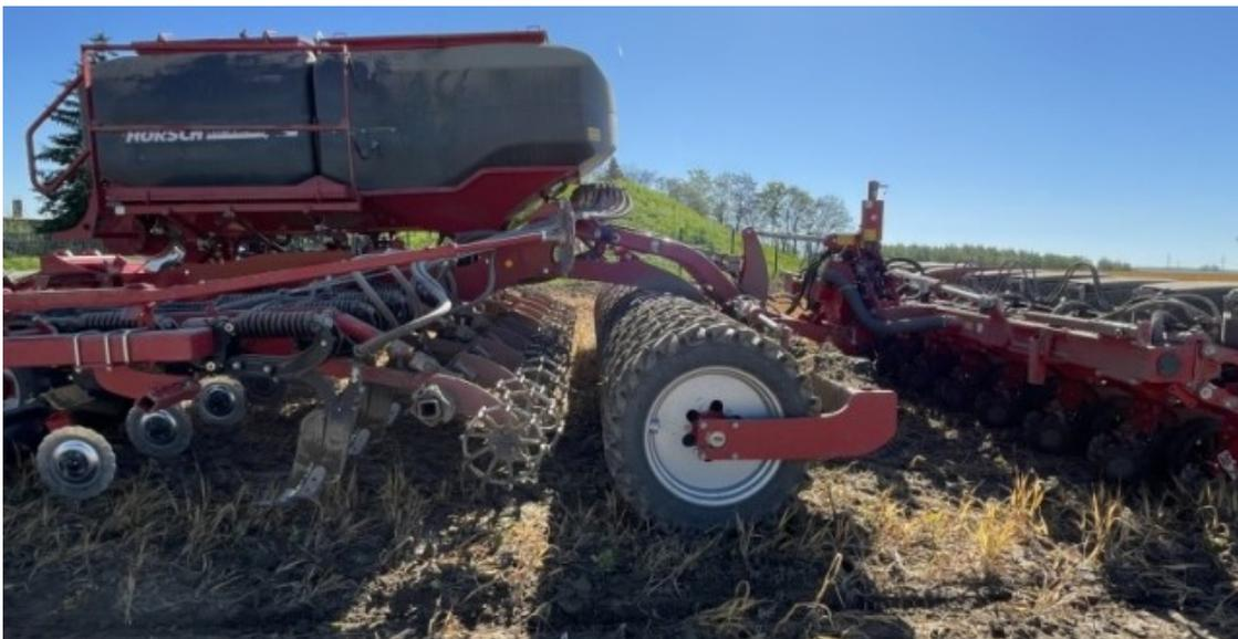
**Abbildung 39: Strip-Till-Sämaschine aus der Baureihe Focus der Firma HORSCH (Bild: AgUmenda GmbH)**
