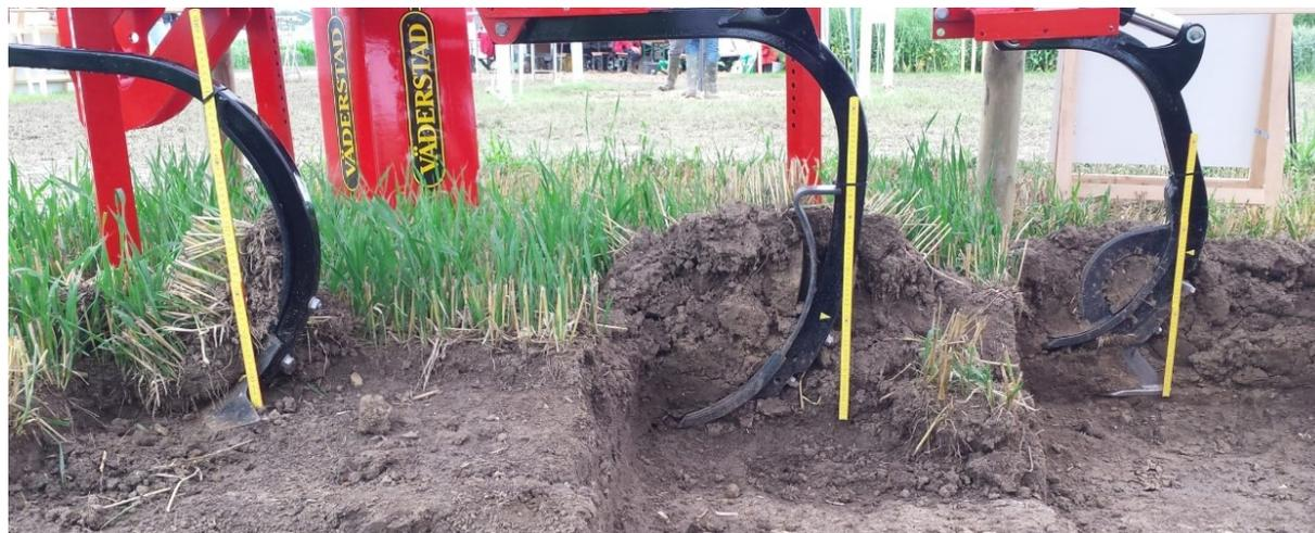
**Abbildung 47: Low-Disturbance Schar mit DeepLoosening Spitze (rechts) und Schmalschar (mittig) für die Bodenbearbeitung zu Raps in der Demonstration; Gänsefußschar (links) (Bild: AgUmenda GmbH)**
