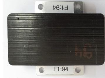
**Abbildung 11: Referenz- Necktag® inkl. SE Mikrocontroller-Zentraleinheit mit Funktechnik und Ortungsfunktion & SE eigener Sensorik und stalltauglicher Necktag®-Gehäusekonstruktion für die Anbringung an fixen Standorten im Stall**
