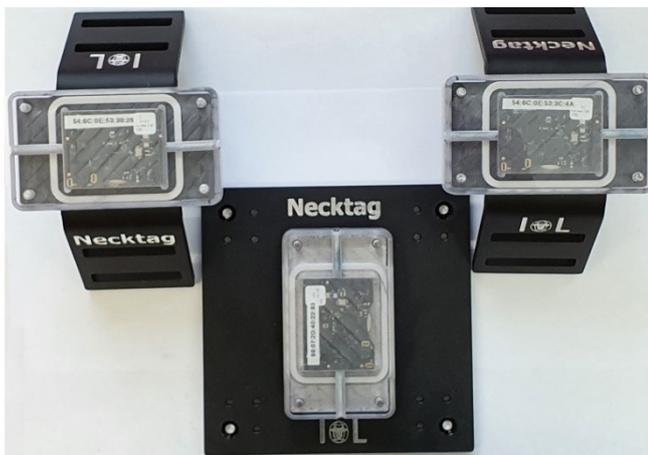
**Abbildung 9: Necktag® Version 0, 2x Tiertag (links und rechts), 1x Referenztag (mittig)**
