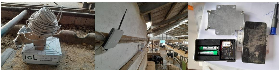
**Abbildung 18: links-Antenne A1 vor der Installation, mitte- installierte Bluetooth-Antenne und rechts weiterentwickelte NECKTAG® Multisensoren**
