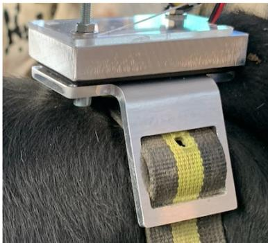
**Abbildung 3: Funktionsmuster für den Test des Peltier-Elementes**
