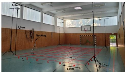
**Abbildung 21: Versuchsaufbau zur Überprüfung der Ortungsfunktion der Necktag® bestehend aus einem 6 m x 9 m großen Raster (rot eingezeichnet), vier Antennen (je eine pro Eckpunkt)**
