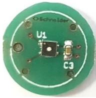
**Abbildung 15: bestückte SE Platine mit einem Luftfeuchte- und Temperatursensor**
