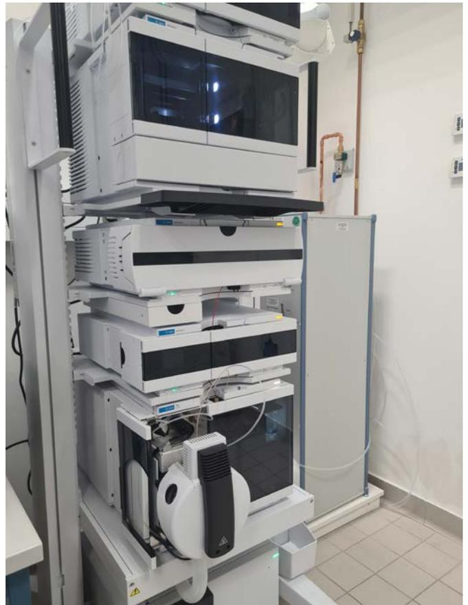
Abbildung 3: Modernes LC-MS/MS Analysengerät an der LUA in Chemnitz
