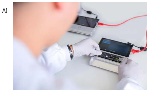
Abbildung 1 A) Der Sequenzierer von Oxford Nanopore ist ein kompaktes Gerät mit integrierter Recheneinheit zur Echtzeitanalyse von DNA und kann eine Fließzelle aufnehmen.
