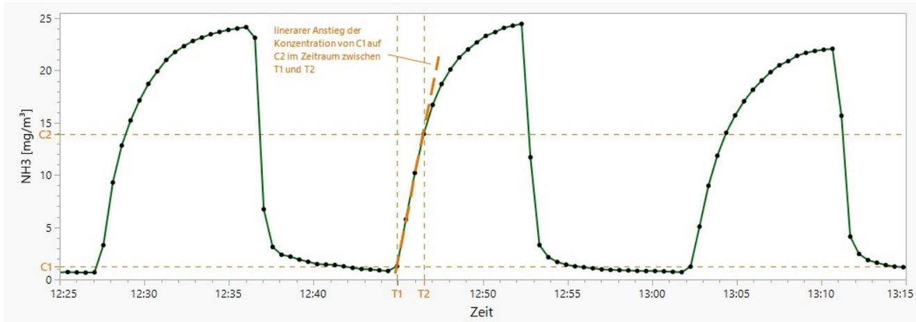
**Abbildung 8: Beispielhafte Darstellung von drei Wiederholungsmessungen an einem Messpunkt sowie eines linearen Konzentrationsanstiegs innerhalb eines definierten Zeitraums**
