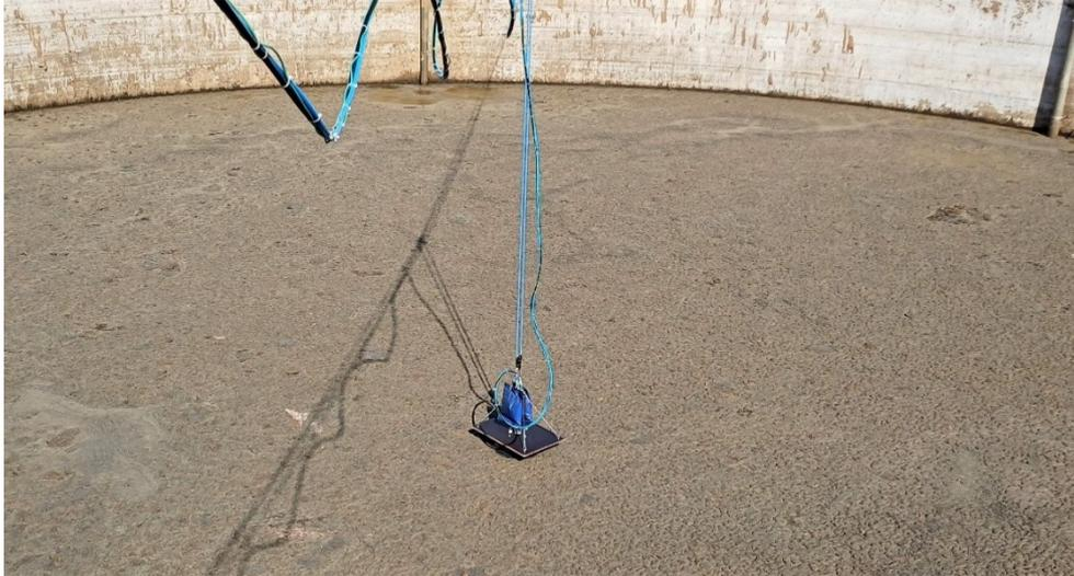
**Abbildung 12: Messung der neu gebildeten Schwimmschicht einen Tag nach dem Homogenisieren**
