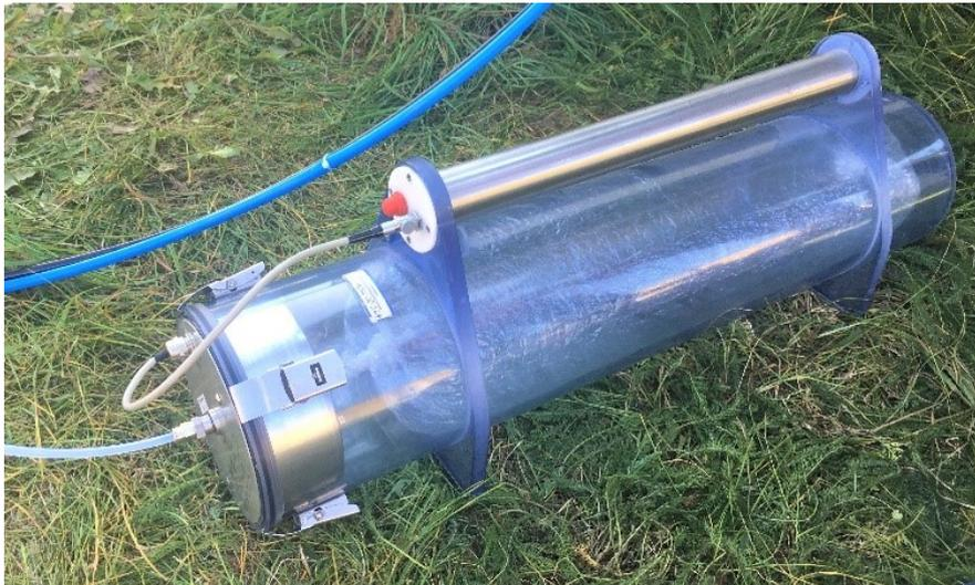
**Abbildung 7: Foto des Geruchsprobenehmers CSD 30 mit gefülltem 10-Liter-Probenahmebeutel**
