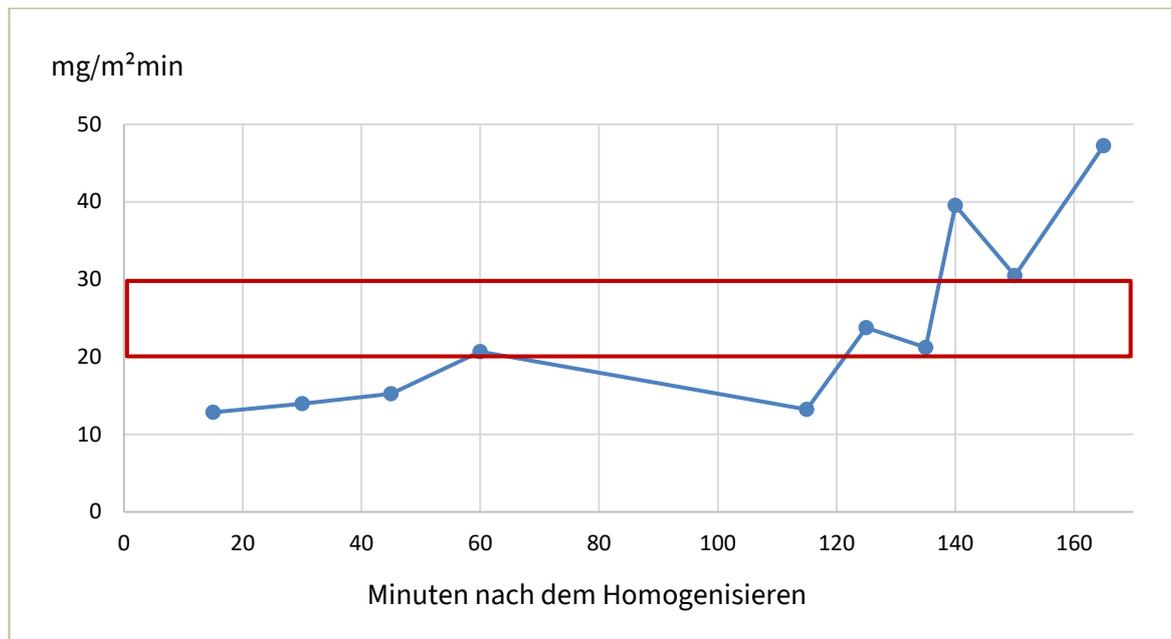
**Abbildung 10: Zeitlicher Verlauf des Anstiegs der Ammoniakemissionen nach dem Homogenisieren über drei Stunden bei Rindergülle**
