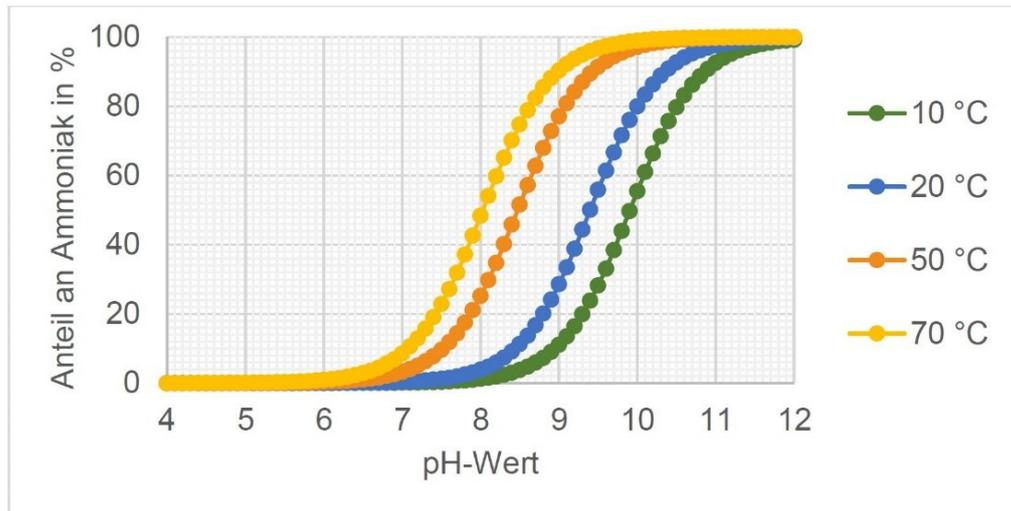
**Abbildung 2: Ammoniak-Ammonium-Gleichgewicht in Wasser in Abhängigkeit des pH-Werts sowie der Temperatur (NÖTZOLD (2021))**
