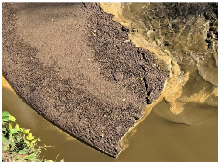
**Abbildung 13: Homogene und stabile Schwimmschicht aus separierten Feststoffen mit einer Dicke von 10-15 cm während der Homogenisierung**
