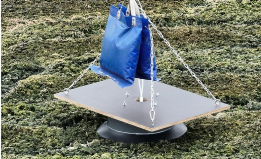
**Abbildung 5: Foto der Messhaube mit Gummikragen und Beschwerung durch Gewichte bei Messung auf einer geschlossenen Schwimmschicht**
