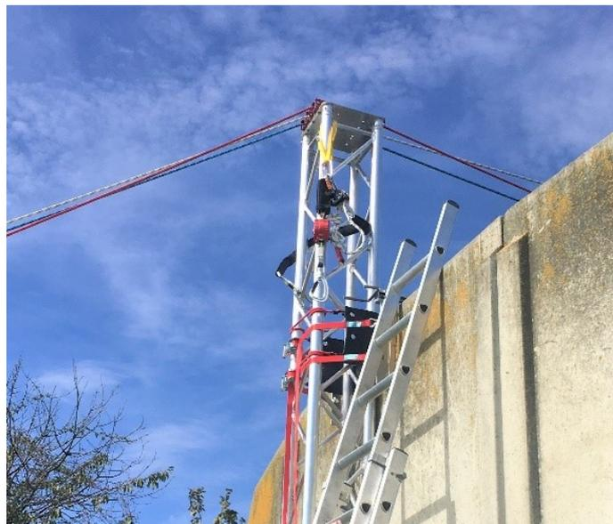
**Abbildung 3: Aufbau der an einem Güllebehälter befestigten Messtrasse mit den verschiedenen Tragseilen zur Bewegung der Messhaube**
