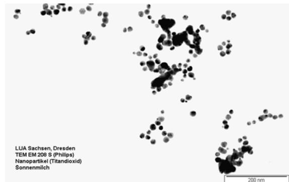
Abbildung 31: elektronenmikroskopische Darstellung von Nanopartikeln in Sonnenmilch
