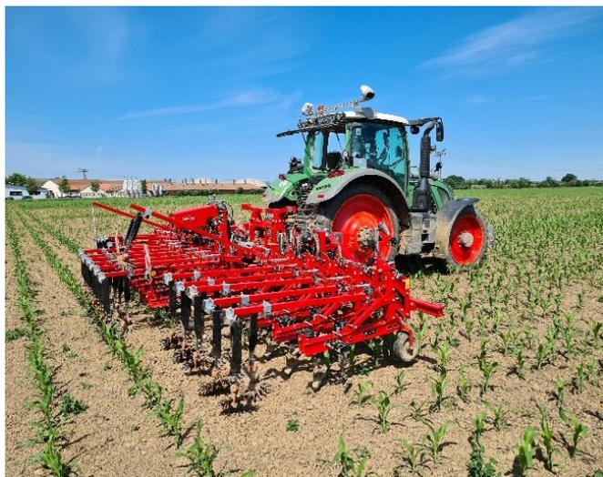
**Abbildung 9: Kameragesteuerte Hacke Steketee vom Typ »EC Weeder« mit drei Einzelsegmenten**
