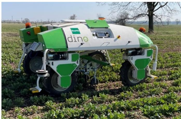
**Abbildung 10: Feldroboter Dino mit kameragesteuertem Verschieberahmen**
