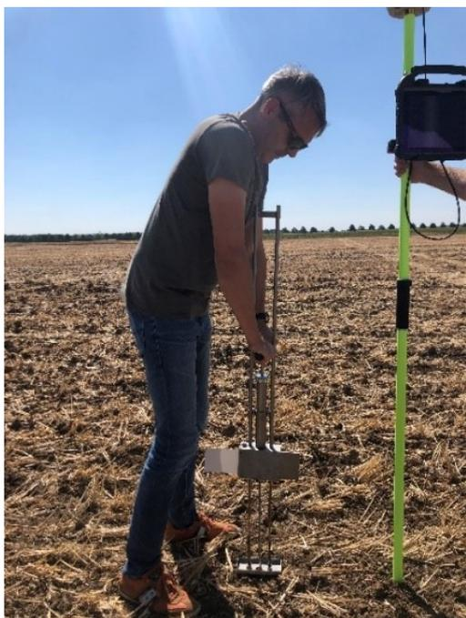
**Abbildung 6: Einsatz des Penetrometers und Einmessung mittels Vermessungssystem**
