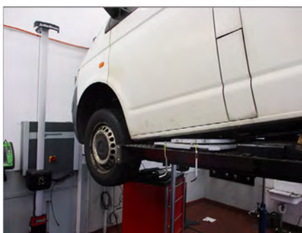
Abb. 29: Hebebühne mit vorgerolltem Fahrzeug, ©LDS
