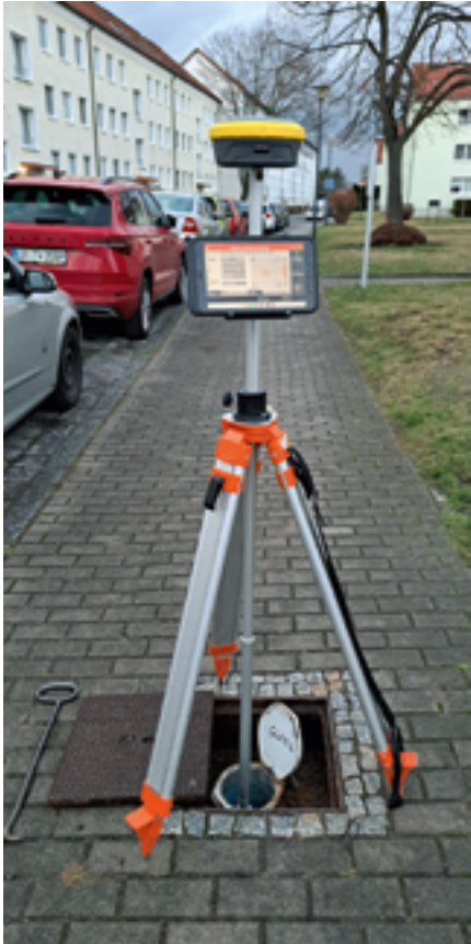
Abb. 9: Koordinatenüberprüfung an einer Grundwassermessstelle mit dem Geomax Zenith 60
