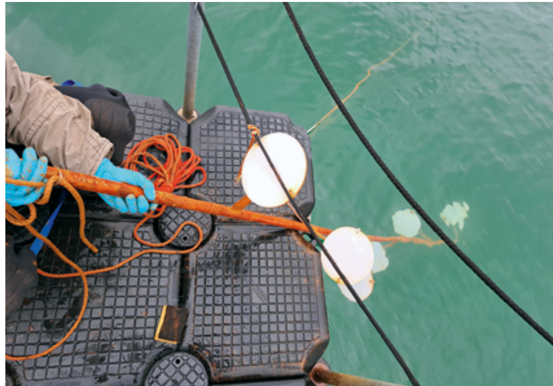
Abb. 11: Ermittlung der zeitlichen Veränderung der Sichttiefe mittels Eigenkonstruktion im Badesee Halbendorf
