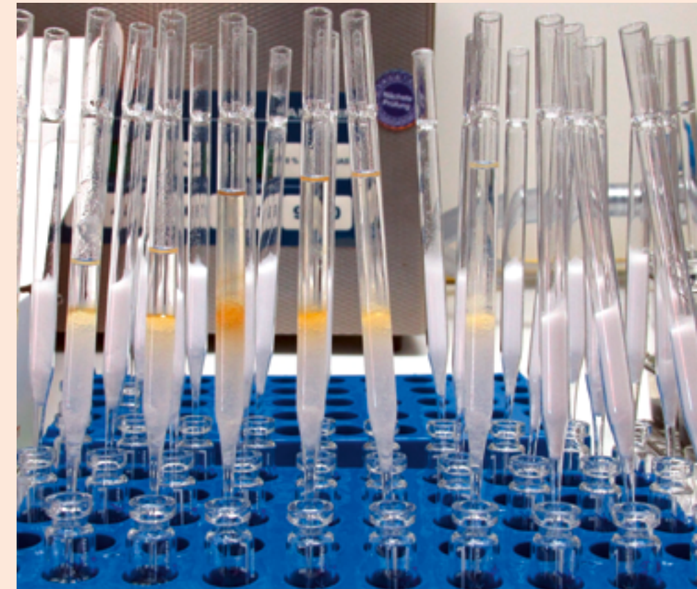
Abb. 2: Extraktion und Aufreinigung (clean up) von Schwebstaubfilterproben für die PAK-Analyse
