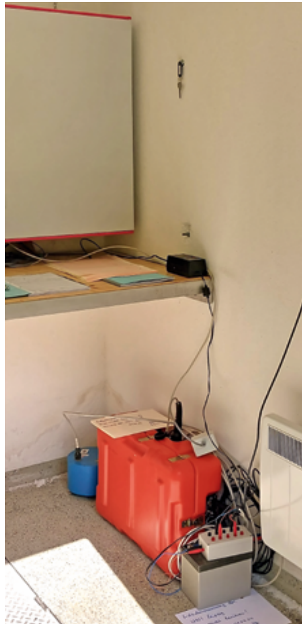
Abb. 15: Seismometer der Uni Leipzig am Pegel Sachsengrund
