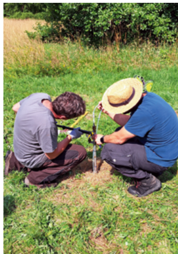
Abb. 5: Beim Anschluss der Messtechnik an die eingebrachte Bodenluftsonde zur Messung von Mofettengasen
