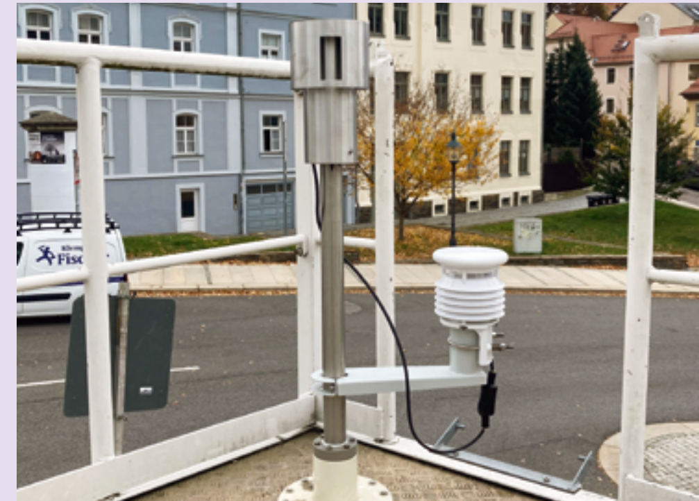
Abb. 2: Sondenkopf für ein Messgerät zur kontinuierlichen, zeitaufgelösten Staubbmessung auf der Basis von Streulichtdetektion (am Standort Freiberg).
