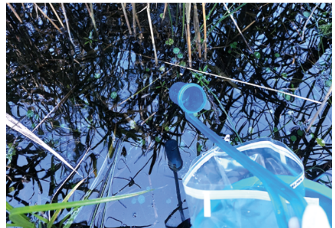
Abb. 13: Wasserprobenahme zur eDNA-Untersuchung (Kristallteich Weißwasser)
