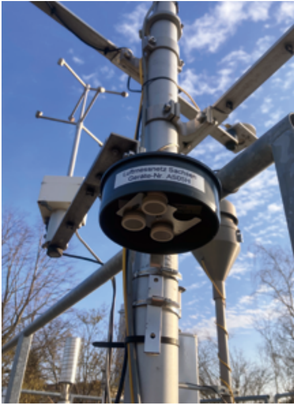
Abb. 3: Passivsammler zur Ammoniakmessung an der Messstation Radebeul-Wahnsdorf
