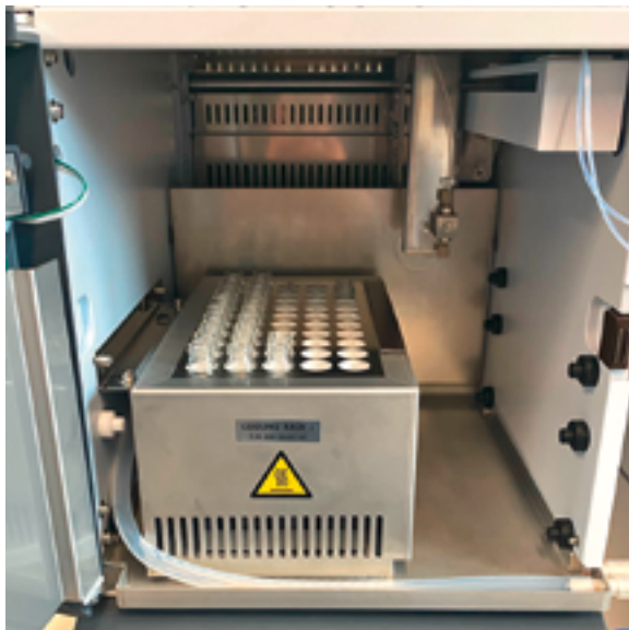
Abb. 4: Fraktionssammler für die Analyse von D-Vitaminen
