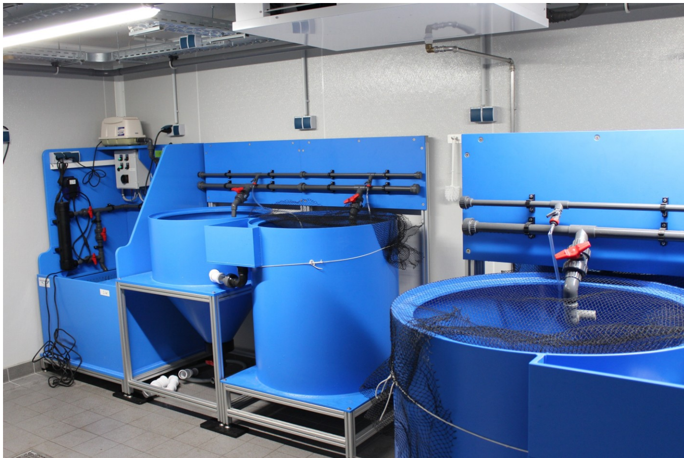
Abbildung 1: In Klimakammer am IfB eingestellte Kleinkreisläufe
