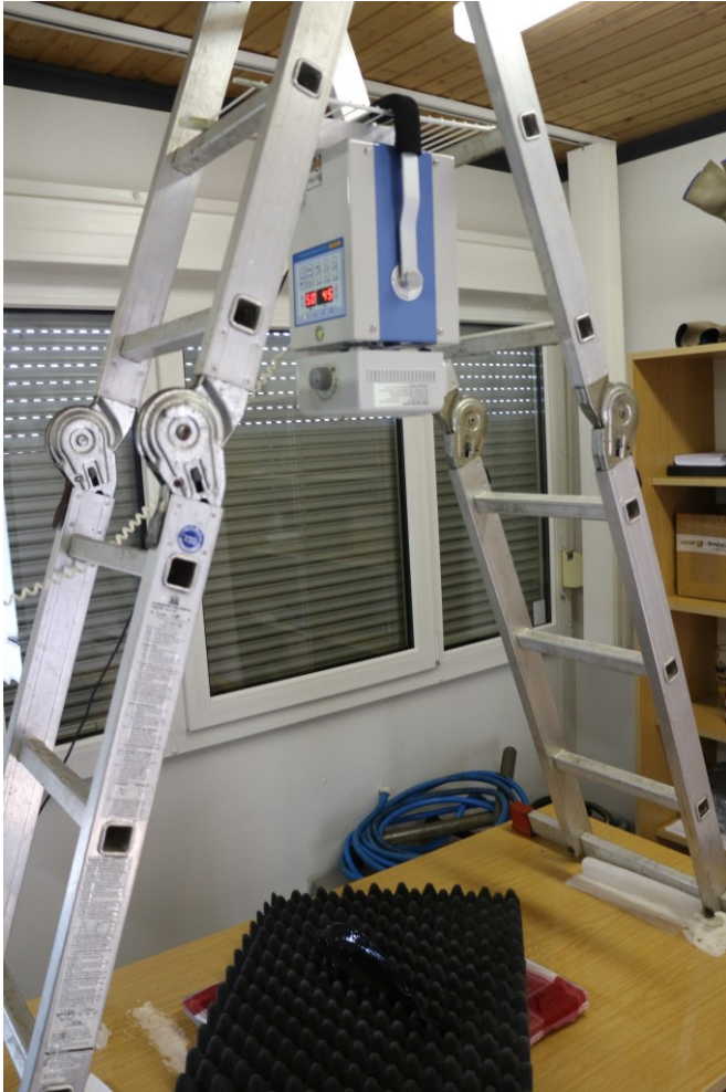
Abbildung 2: Setup der Röntgenausrüstung zur Erhebung von Deformationen bei Karpfen (dorso-ventrale Aufnahme)
