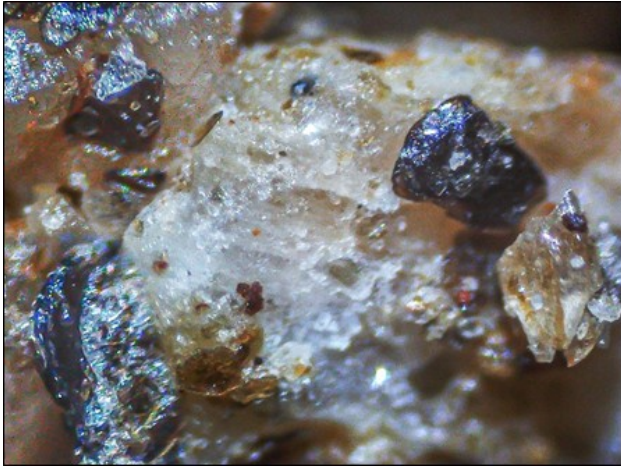
Abbildung 5: Ideomorpher Zirkon (links oben) in einer Granodiorit-Basislage, Dresdner Heide. Bildbreite 1 mm
