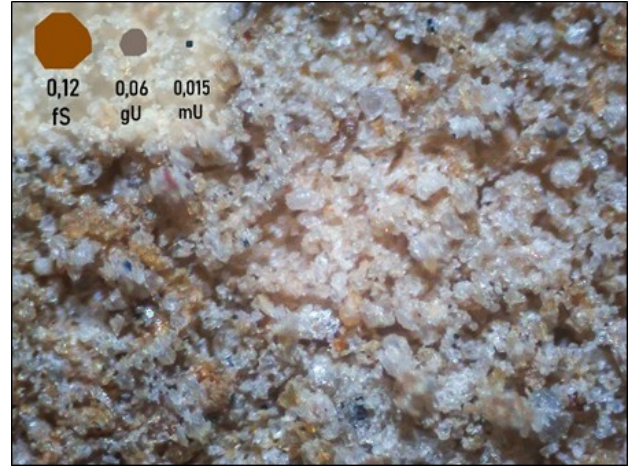
Abbildung 6: Lösslehm der Hauptlage mit sehr hohem Quarzanteil, Region Hainichen, oberes Lösshügelland. Bildbreite 1 mm
