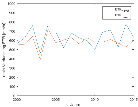
Abbildung 29: Vergleich der jährlichen realen Verdunstung der DIFGA-Analyse mit der Raven-Simulation (links) und Vergleich der Grundwasserzulufluss (rechts) für das Gebiet Dohna im Zeitraum 2000-2015
