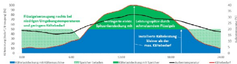
Spitzenlastdeckung mit Flüssigeis Beispiel: Kältebedarfsdeckung eines Bürogebäudes oder einer Produktionsstätte
