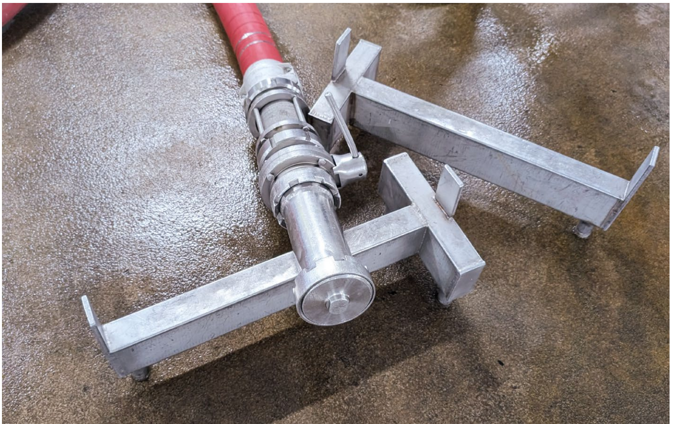
Abbildung 32: Sachgemäße Ablage eines Schlauches zur Befüllung eines Tankfahrzeugs bei einer Brauerei (Foko: IKL)
