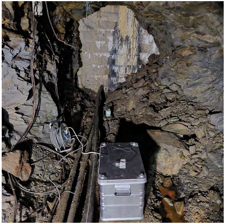
Abb. 3.2-4: Seismometer (im Hintergrund) und Schutzkiste des Datenerfassungssystems (im Vordergrund) an der Station TH.TIER „Stollen Tierberg Steinach“. Die Messstelle befindet sich unter Tage im Stollen Tierberg (Foto: D. Schönwald).
