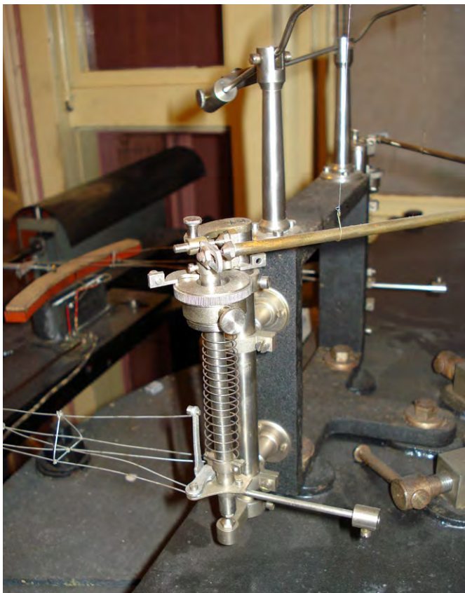
Abb. 5.1-10: Winkelhebel (Mitte), Registrierarm (links) und obere Schubstange (rechts Mitte). Die über die Schubstange kommende Bewegung wird an den Winkelhebel weitergeleitet und auf den Registrierarm mit der Schreibspitze (hier nicht sichtbar) übertragen.
