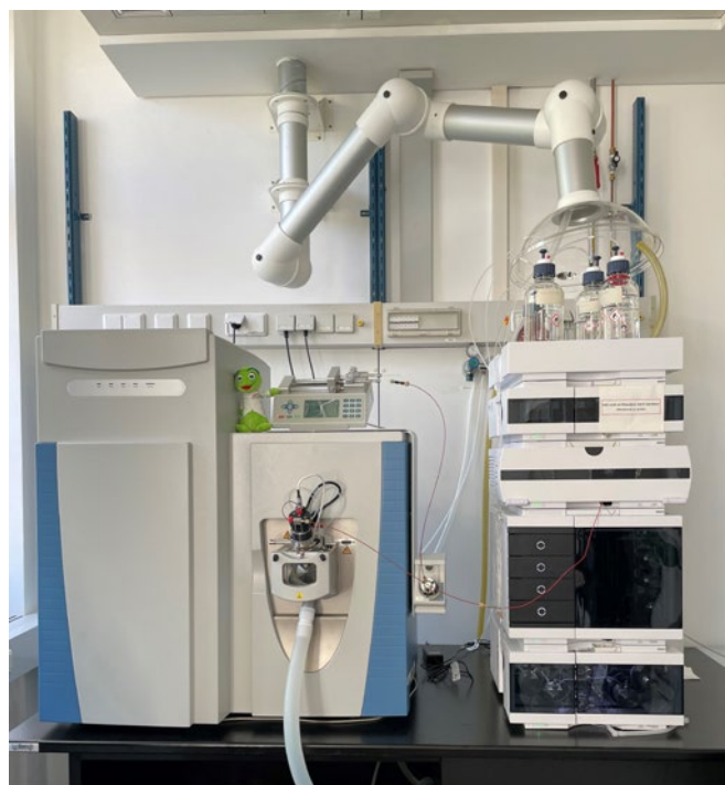
Abbildung 2.4: HPLC-Orbitrap zur Analytik von Honiginhaltsstoffen
