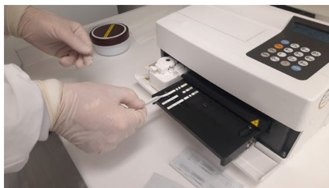
Abbildung 1.1: Quantitative Bestimmung der Aktivität von Leberenzymen im Serum mit einem Trockenchemie-Vollautomaten
