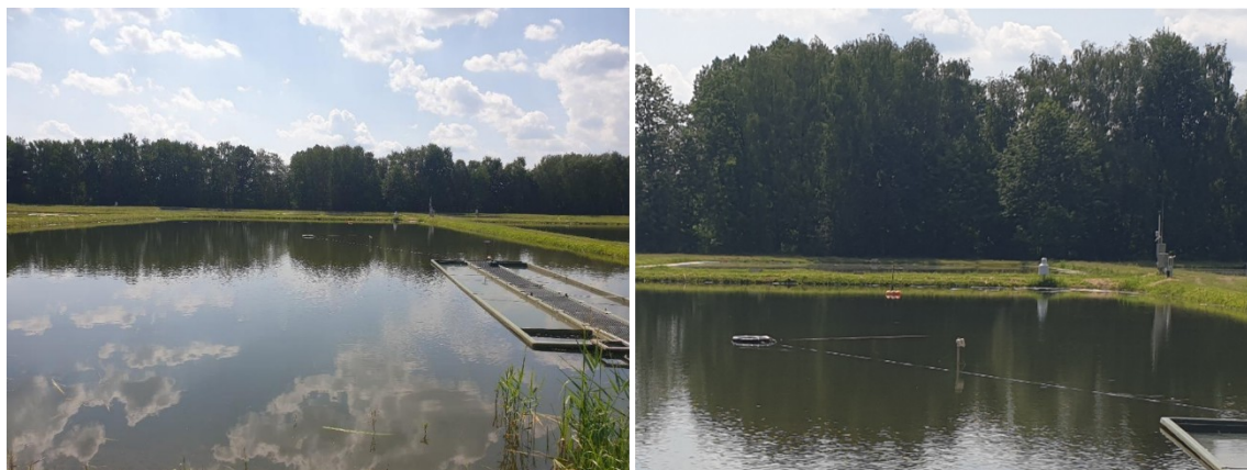
Abbildung 16: Messung verdunstungsbedingter Wasserverluste mittels schwimmender Lysimeter auf der Versuchsteichanlage des LfULG in Königswartha
