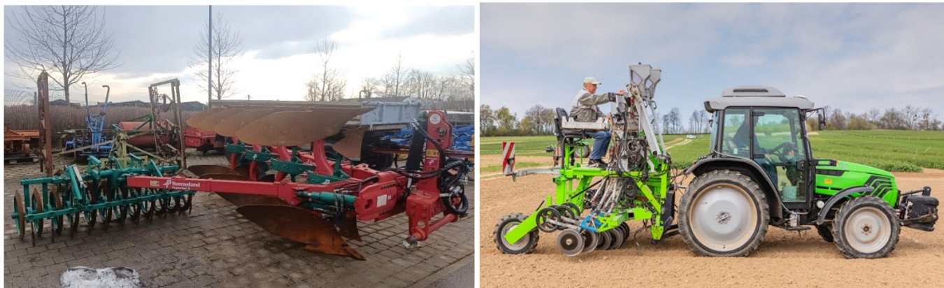
Abbildung 4: links: 4-Schar-Wendepflug mit Zahnpackerwalze; rechts: Parzellendrillmaschine von Wintersteiger mit Lemken Doppelscheibenschar
