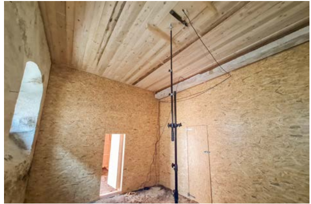
Fertige Testzellen mit OSB-Plattenbeplankung und Klimamesstechnik unter dem Holztafelmodell
