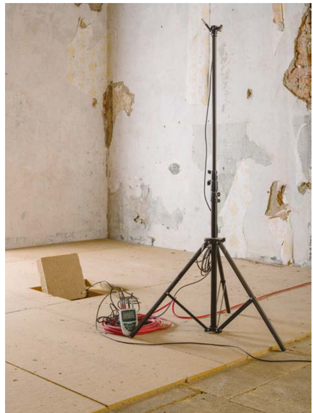
Versuchsfeld, vorne Lehmbauplatte, hinten Holzweichfaserplatte
